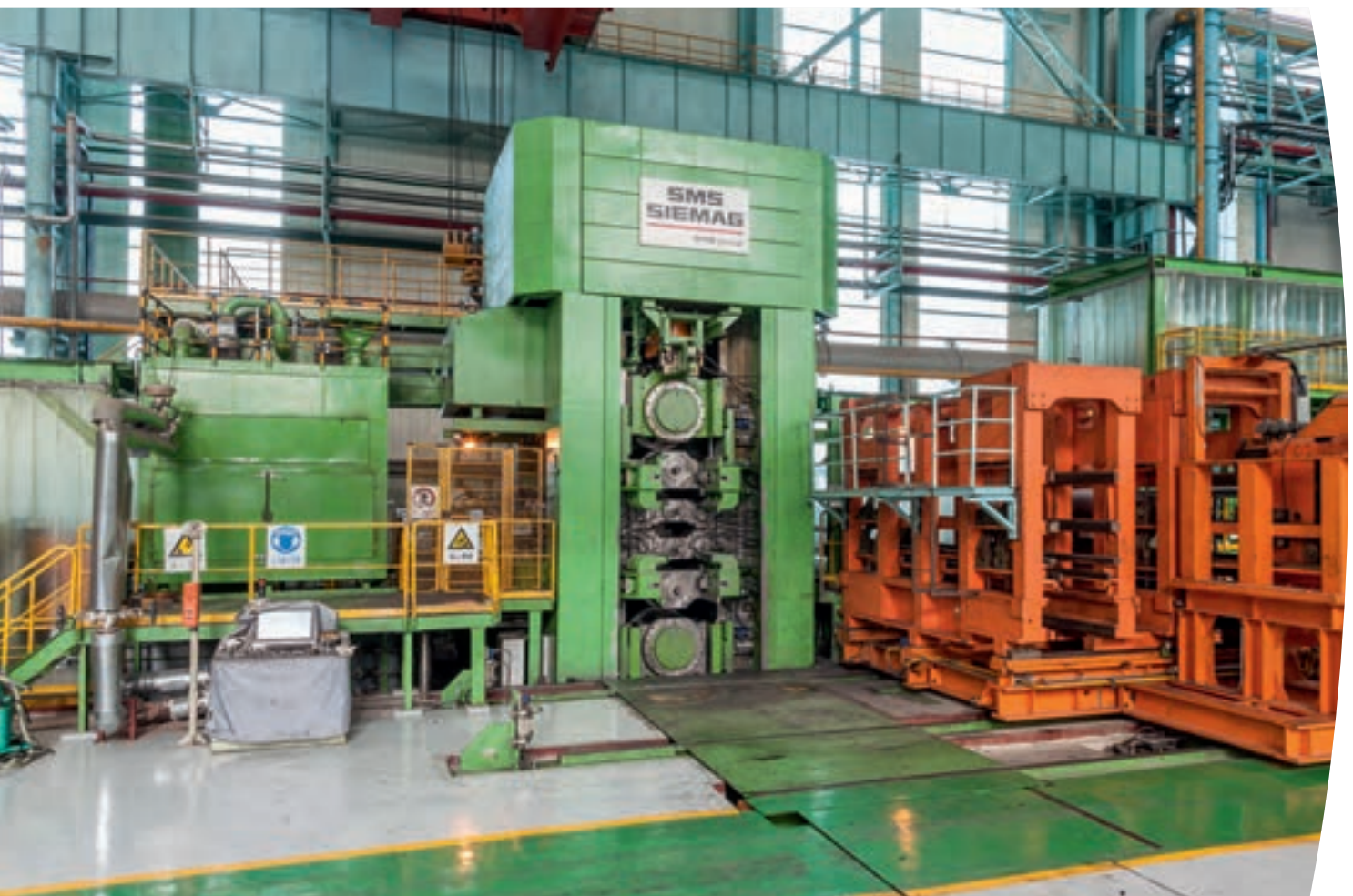
ISPM in CAL: Bedienerseite mit Vorrichtungen für den schnellen Walzenwechsel.
