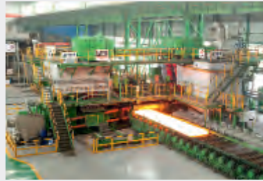
Slab sizing press
