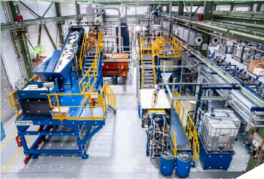
Das Batterie-Recycling von Primobius kombiniert mechanische und hydrometallurgische Verfahren.
