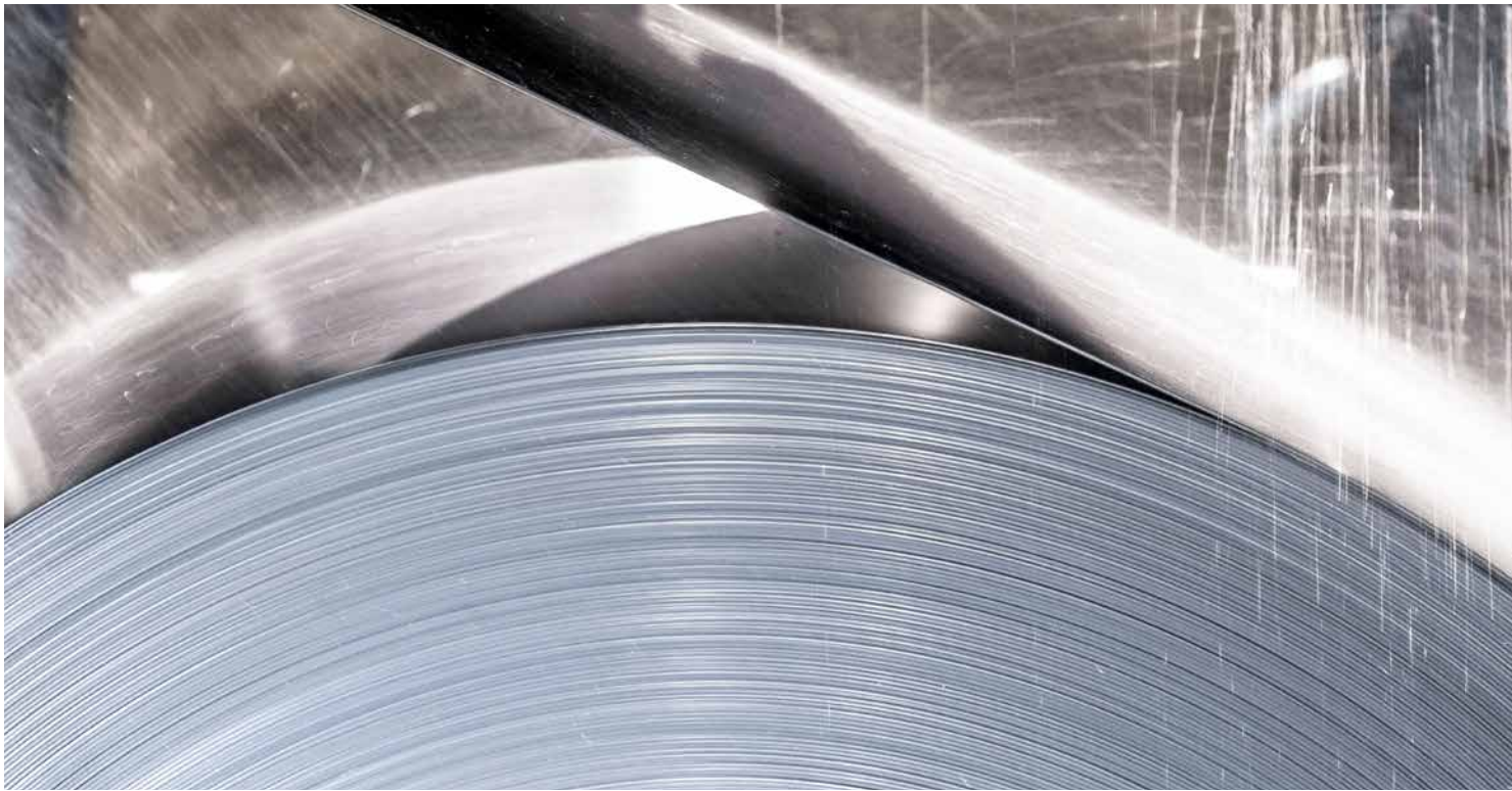
Auf der Anlage produziert PTKS Warmbänder von 600 bis 1.650 Millimeter Breite und 1,4 bis 16 Millimeter Dicke.
