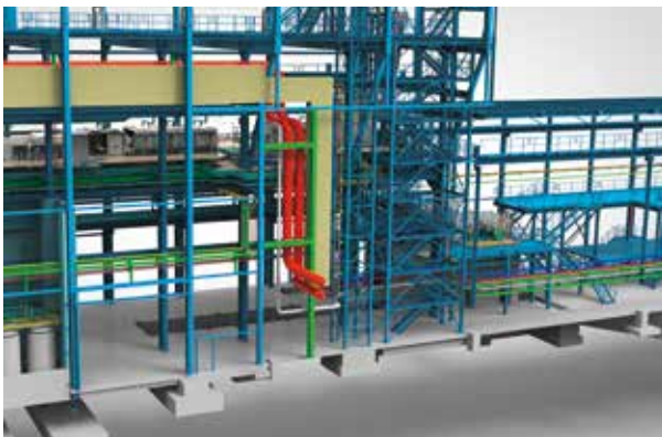
Kollisionskontrolle – hier Unterstützungsstahlbau, Prozessverrohrung, Kabelwege und Laufwegeplanung.
