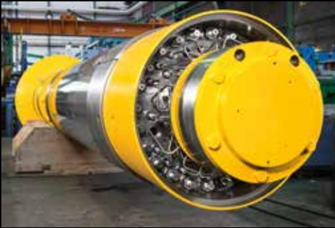
Blick auf das optimierte Fettschmiersystem ohne montierten Schutzdeckel.
