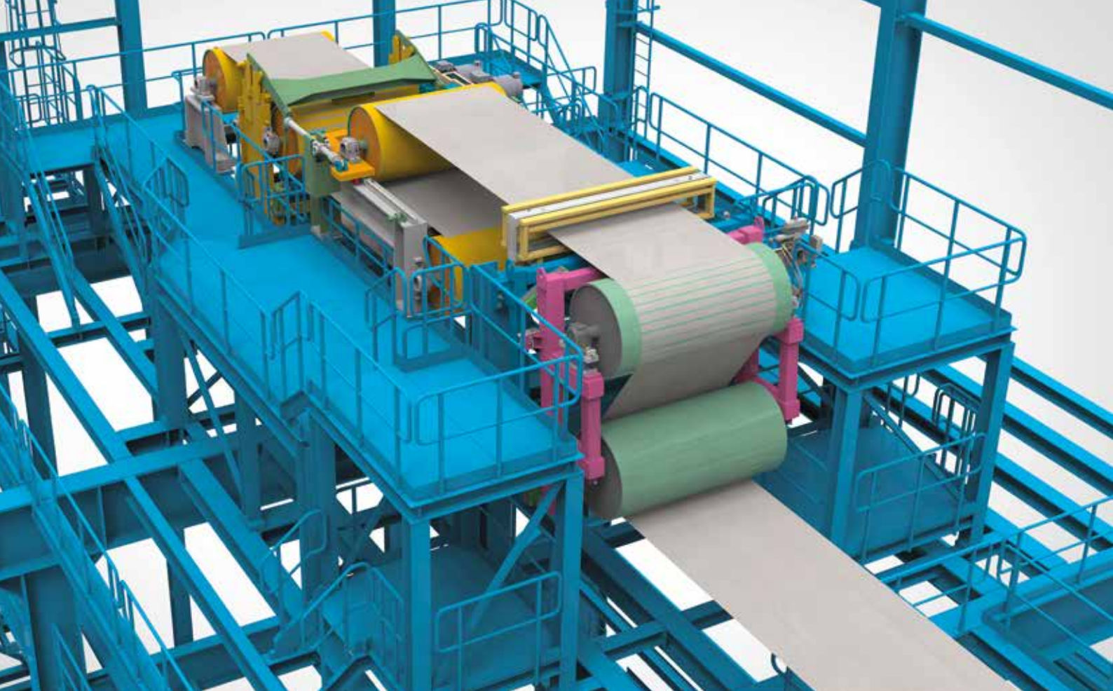
Maschineneinplanung – Bedienplattformen und Zugänglichkeiten für das Wartungspersonal.
