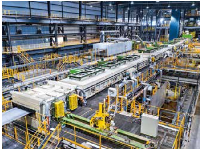
Die Turbulenztechnologie erzielt in den flachen Tanks mit minimiertem Säure- und Energieeinsatz maximale Beizwirkung.
