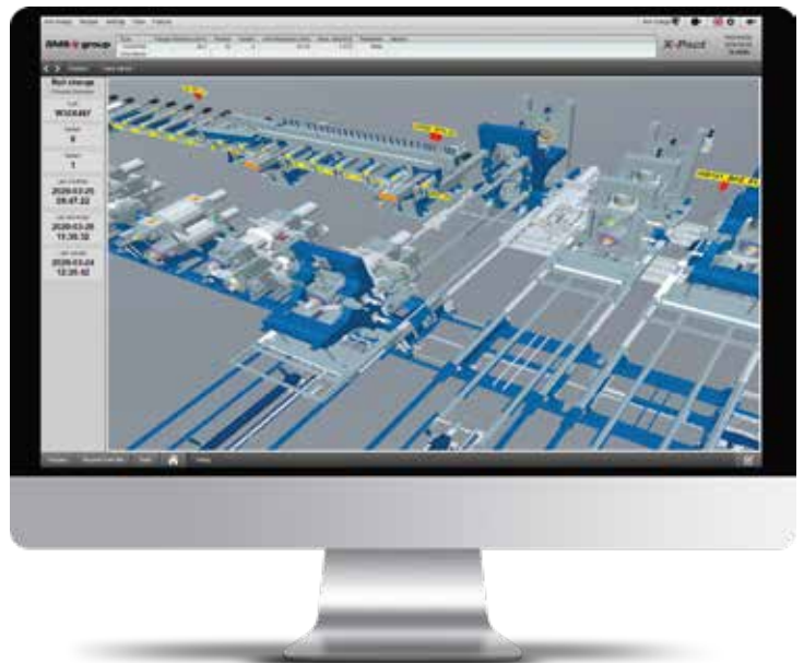
Digitaler Zwilling der CCS®-Tandem-Reversiergruppe für Breitflansch- und Doppel-T-Träger, der funktional und technologisch für die realitätsnahe 3D-Echtzeit-Anlagensimulation nachgebaut wurde.
