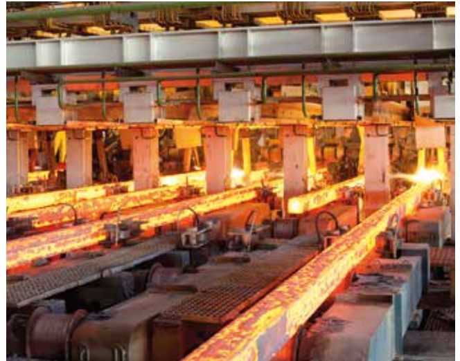
Strangguss auf acht Strängen mit Hochgeschwindigkeitstechnologie von SMS Concast.
