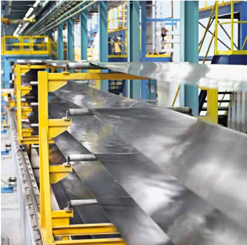
Horizontaler Bandspeicher in einer Glüh- und Beschichtungslinie für nicht kornorientiertes Elektroband.
