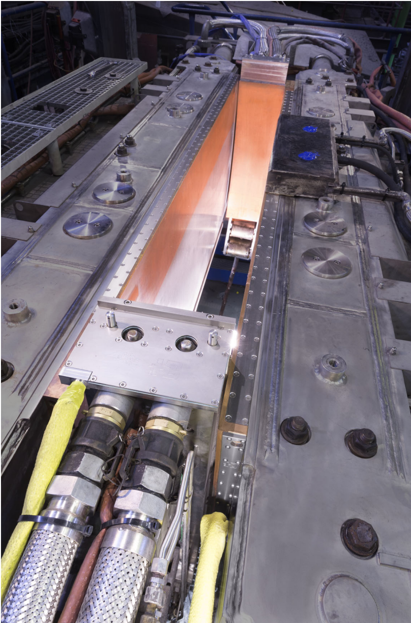
HD mold FO -Kokille für die Dickbrammeproduktion.
