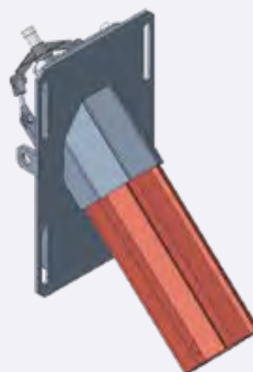
3D-Konstruktion des SMS group-ConSo R6-Injektors.
