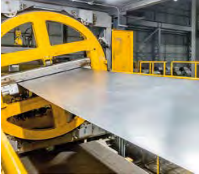
Bestandteil des neuen Auslaufkonzepts ist die hochmoderne Offline-Inspektionsstation des Typs Rotary Inspect, die eine schnelle und besonders ergonomische Untersuchung der Bandober- und Bandunterseite ermöglicht.
