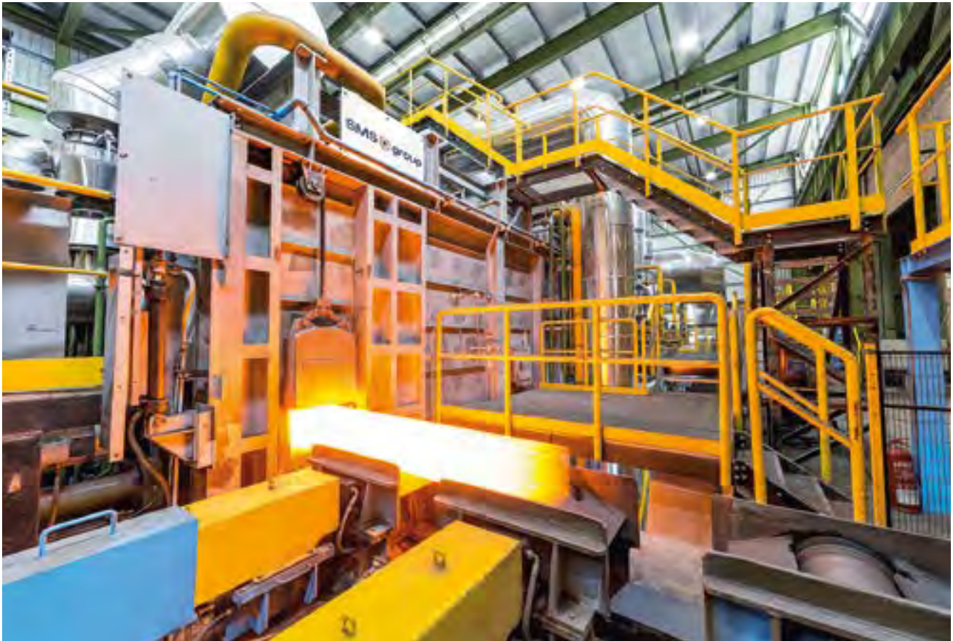
SMS group installierte einen neuen Hubalkenofen mit den zugehörigen Einlauf- und Auslaufanlagen.
