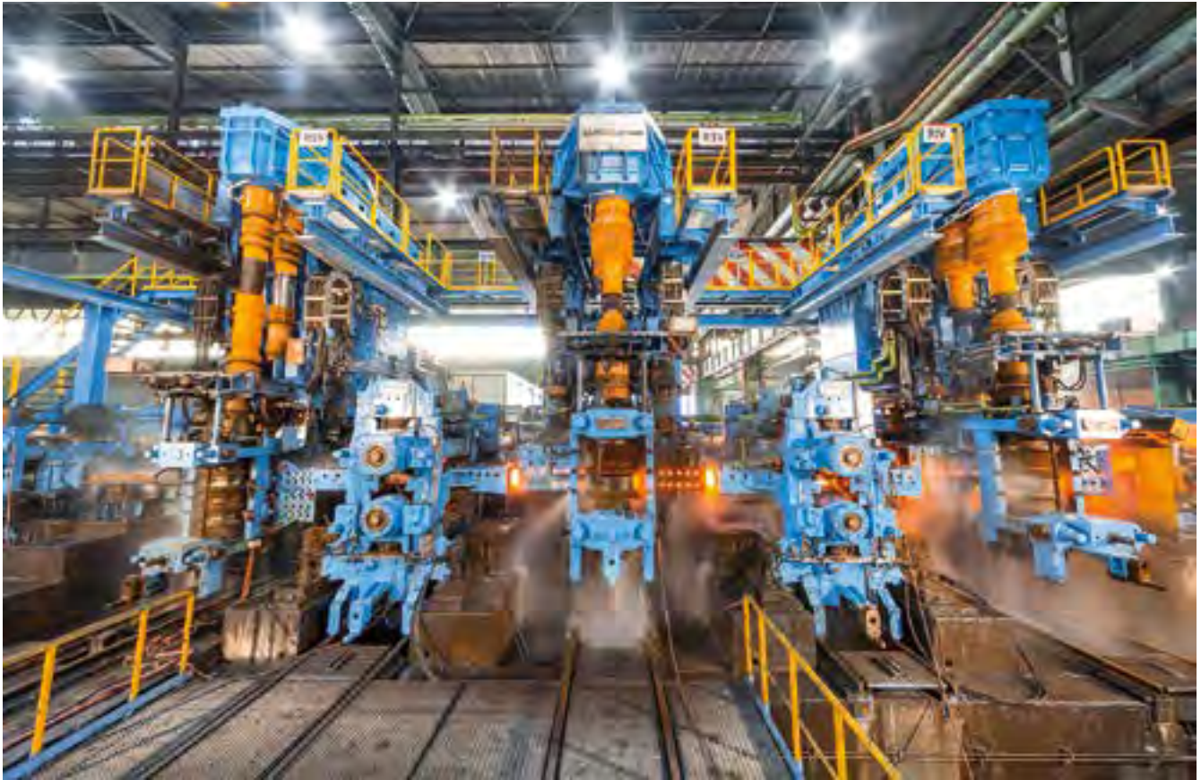
Das bestehende Trio-Vorwalzgerüst wurde durch eine sechsgerüstige kontinuierliche Vorstraße mit Kompaktgerüsten ersetzt.
