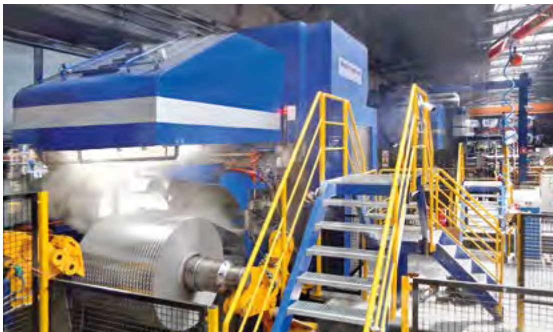
Produktion von Riffelblechen auf der von der SMS group modernisier- ten Aluminium- Kaltwalzanlage.
