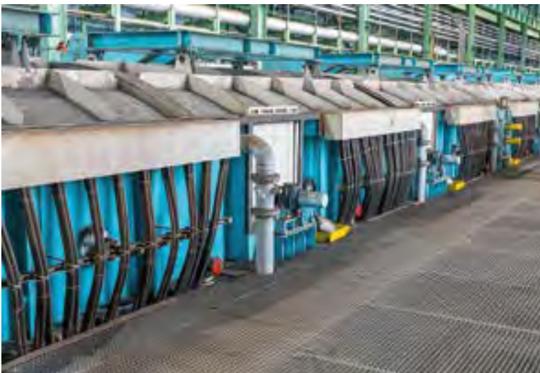
Die Beizsektion liefert ein gutes Beizresultat bei niedrigen Verbräuchen und hohen Geschwindigkeiten und beinhaltet elektrolytische Sektionen, eine Turbulenzbeizsektion sowie einen Spülbereich mit oszillierenden Bürsten.
