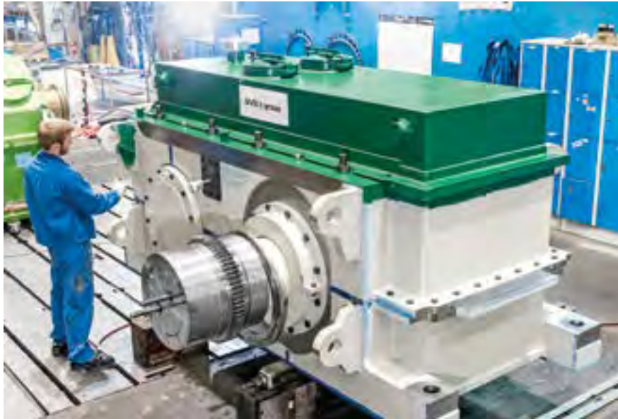
Letzter Schritt bei der Fertigung: Das neue Getriebe für Novelis Nachterstedt wird angestrichen.
