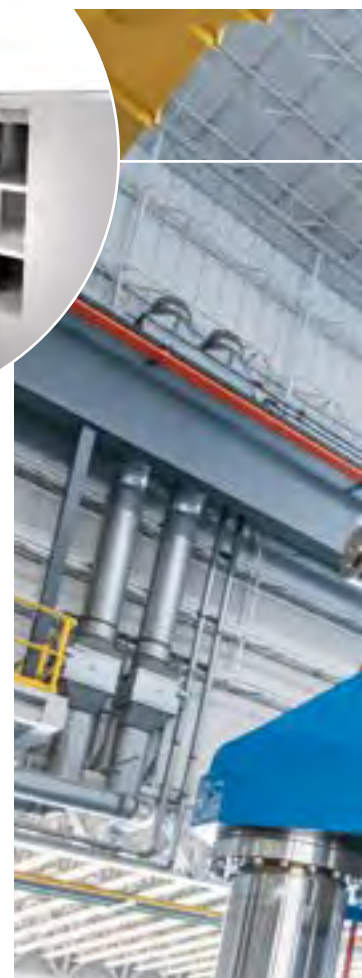
Schema der gelieferten Unterflur-Schmiedepresse mit einer Presskraft von 540 MN (60.000 Short Tons).
