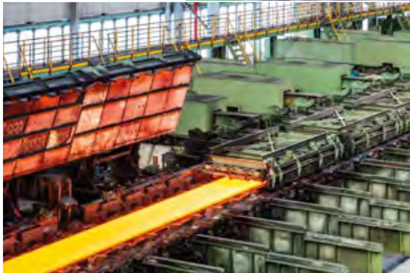
Die Wärmedämmhauben reduzieren die Wärmeverluste im Vorband.
