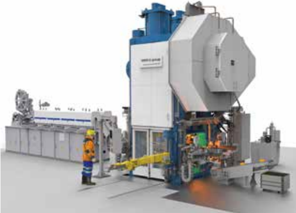
Erste vollautomatische Schmiedelinie für gratis geschmiedete Kolben für Pkw und Lkw in China.
