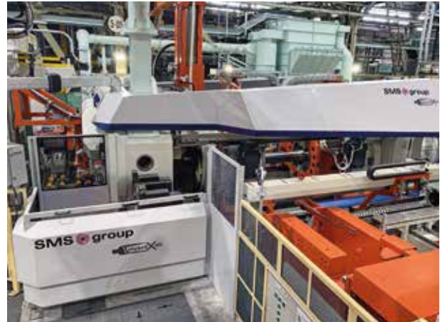
Die HybrEx®40-Pressen ist das zentrale Element der Strangpresslinie der UACJ Extrusion Nagoya Corporation.
