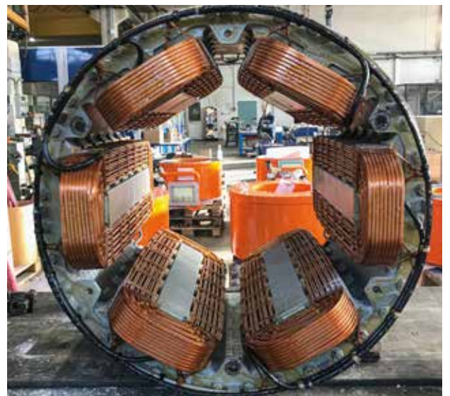
CONSTIR ReNew macht aus Alt wieder Neu: abgenutzte Spulen (oben), neu montierte Spulen während einer Kompletterneuerung (unten).
