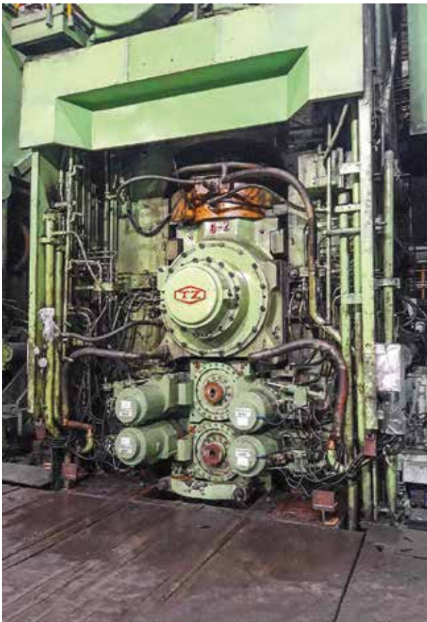
Eines der Fertiggerüste in der Warmbandbandstraße Nr. 1 von Benxi Iron & Steel nach Einbau des CVC®plus-Systems.
