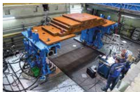
Oszillations-Hubtische müssen nach längerem Gebrauch ausgewechselt und generalüberholt werden.
