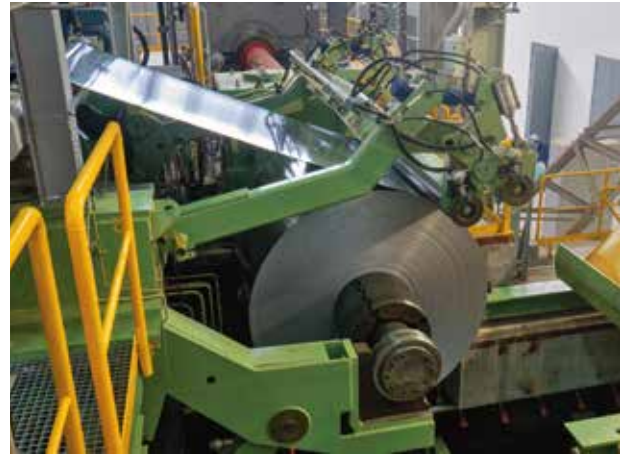
Das erste Band hatte eine Breite von 1.780 Millimetern und wurde auf eine Enddicke von 2,8 Millimetern gewalzt.
