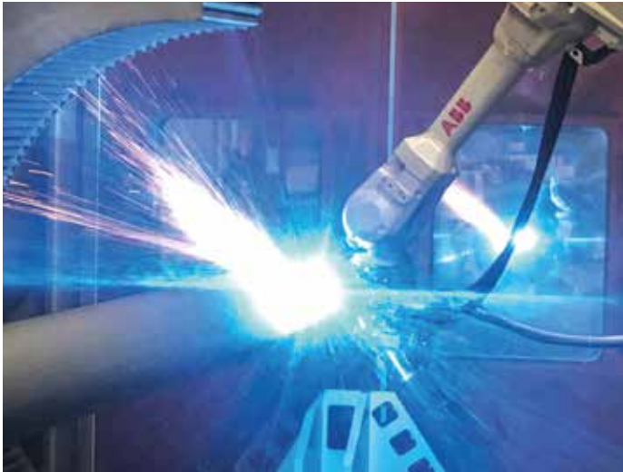
Thermische Beschichtung einer Dornstange mittels PERFECT spray®.
