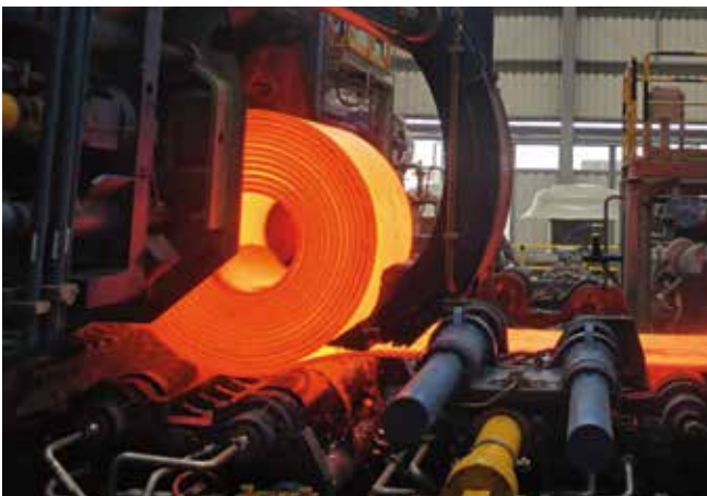
Die dornlose Coilbox reduziert die Temperaturverluste des Vorbandes und speziell die der inneren Windungen.
