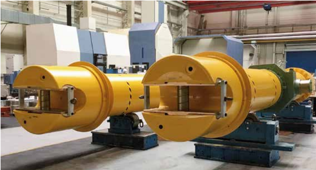
SMS-Flachzapfenspindeln sichern höchste Drehmomentübertragungen (Bild aus der Werkstattmontage).
