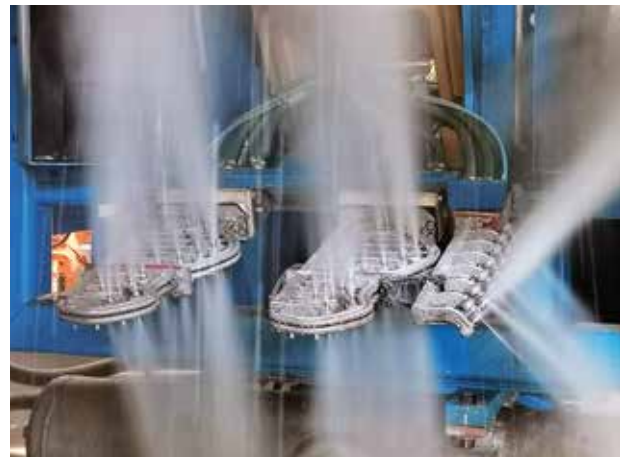
Das Sprühsystem mit den 3D-gedruckten Sprühhöpfen.
