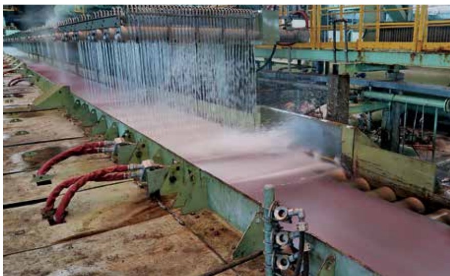
Участок охлаждения на выходе модернизированного SMS group стана горячей прокатки на предприятии Ningbo Iron & Steel. Помимо ламинарного охлаждения, была усилена система поперечного опрыскивания.
