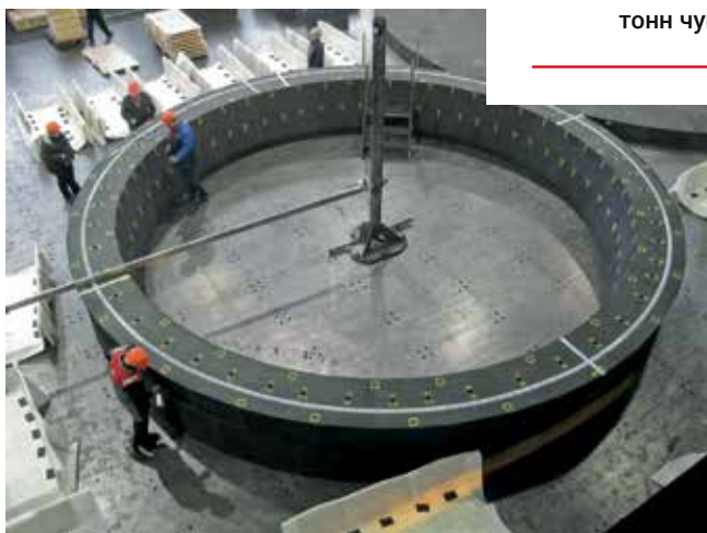
Контрольный монтаж кольцевых слоев горна из углеродных блоков в цеху.
