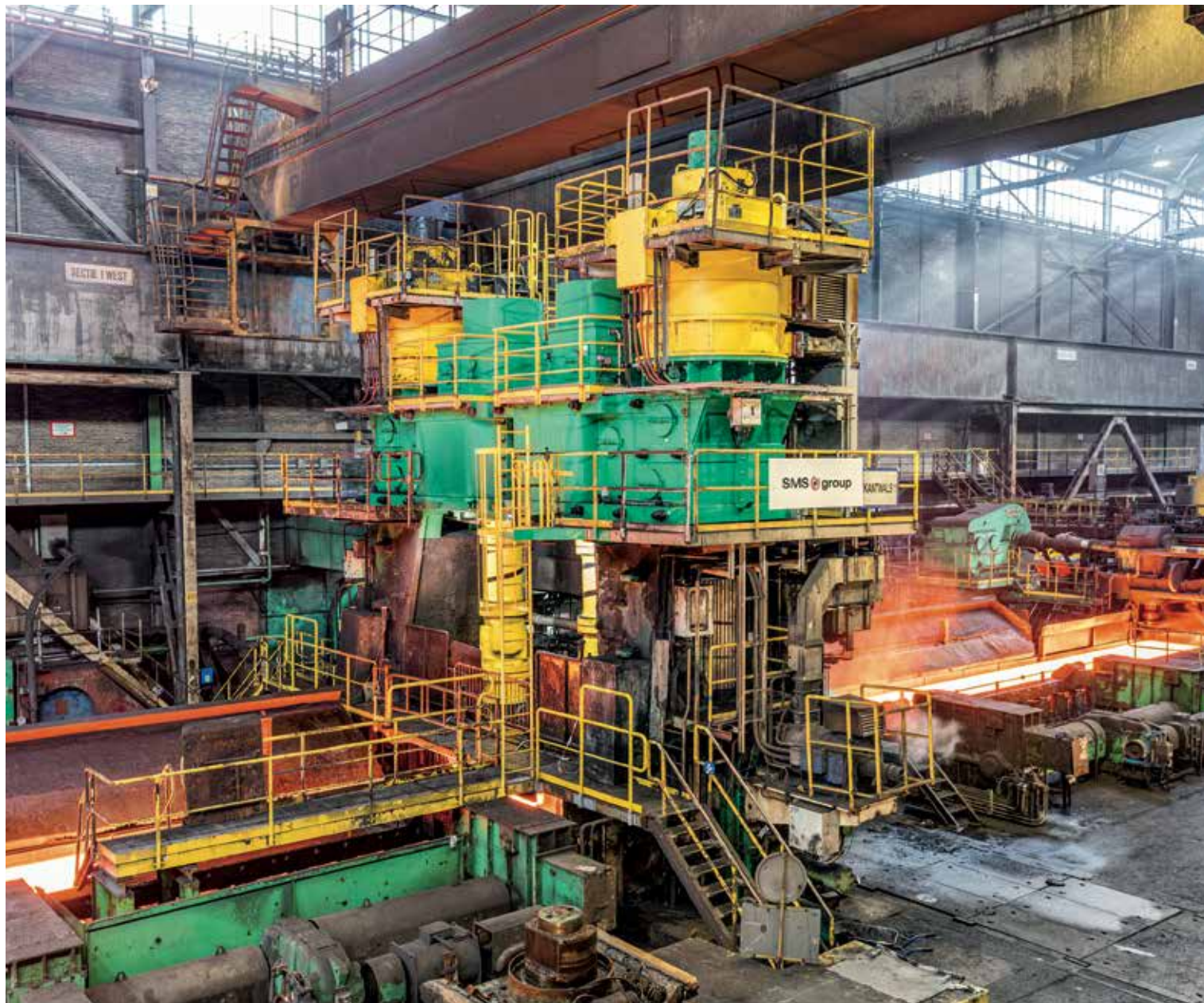
После: обжимная клеть после модернизации.
