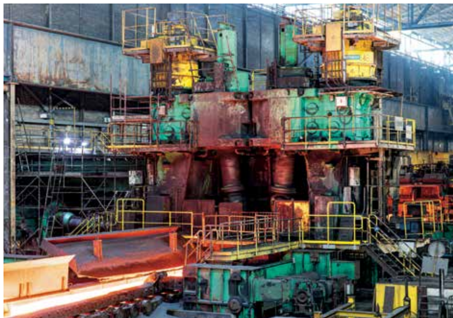
До: обжимная клетка до модернизации.
