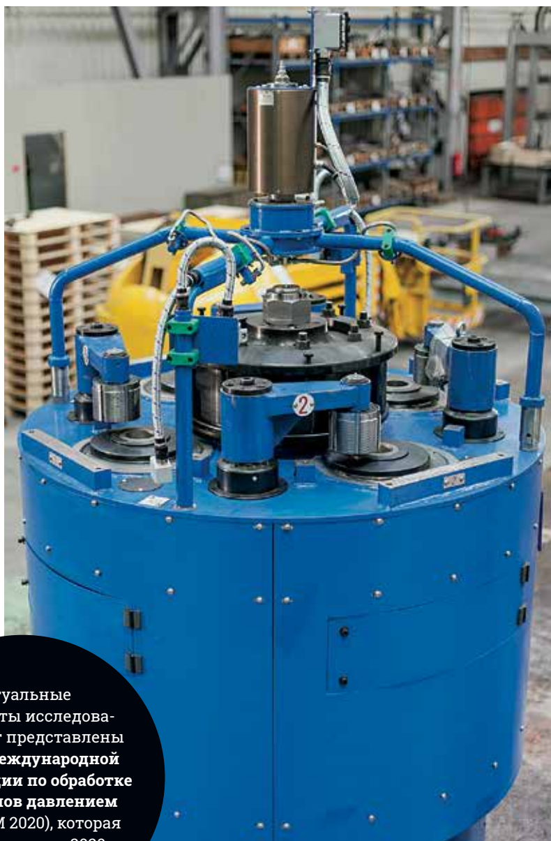
Новая разработка SMS group – кольцепрокатный стан KFRWt neo.
