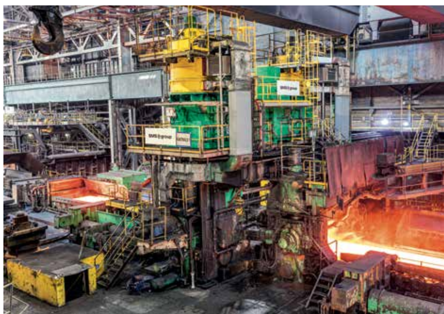
После: черновая клеть с обжимной клетью после модернизации. Вид со стороны выхода.
