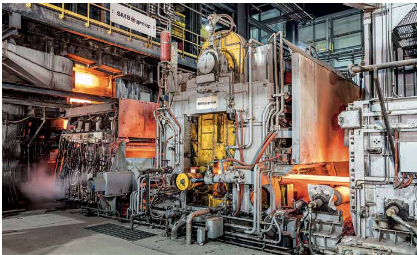
Изображение аналогичной тонкослябовой МНЛЗ в действии.
