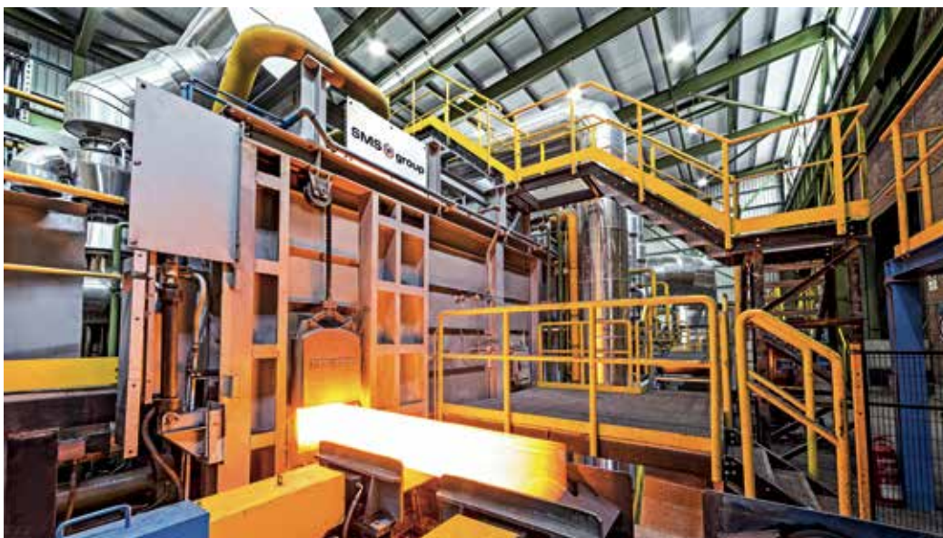
SMS group увеличит производительность печи с шагающими балками на предприятии Sidenor Basauri с 85 до 130 т в час.
