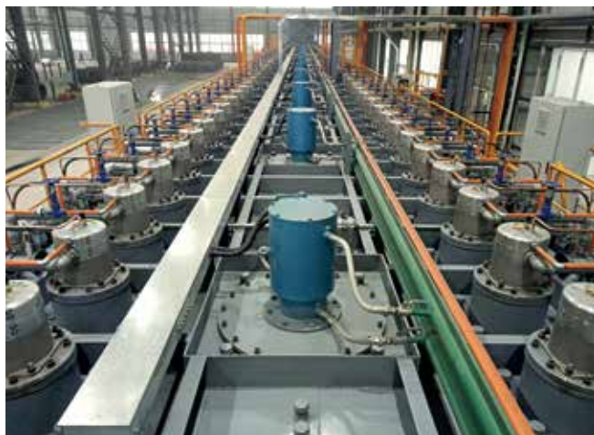
Радиационные трубы нагревают печь до 850 °С.
