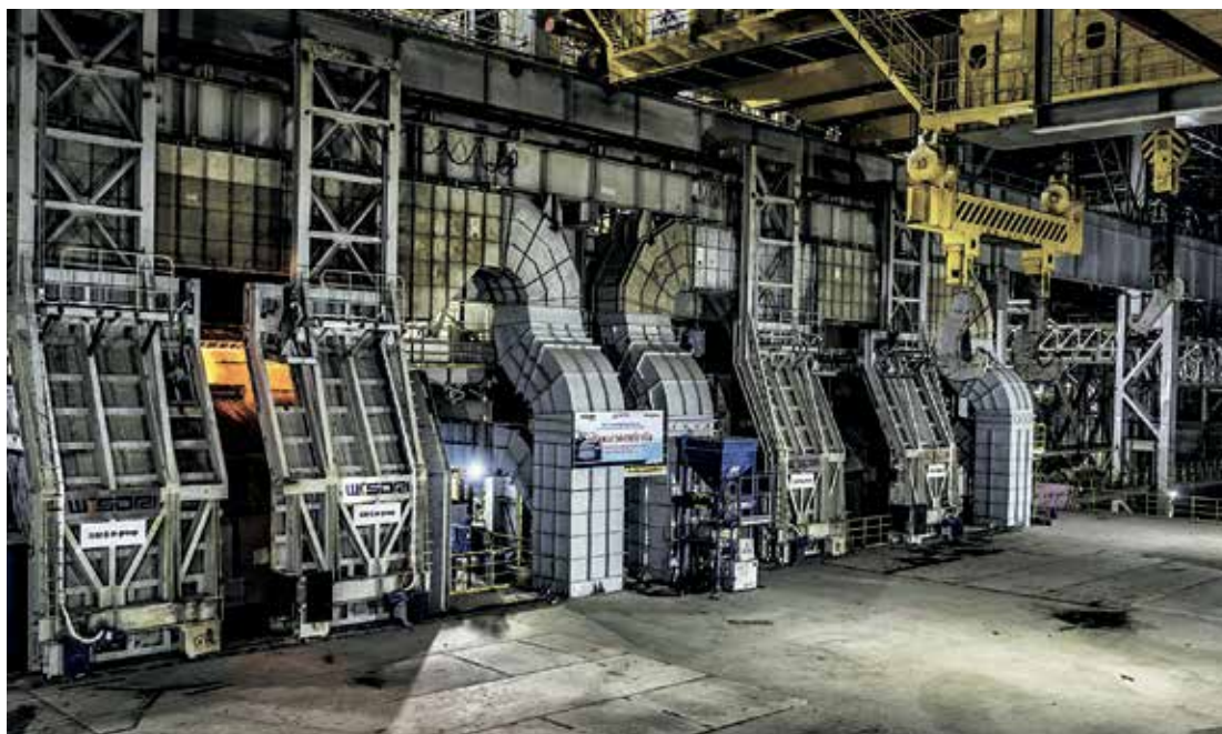
Четыре 120-тонных конвертера оснащены не требующей техобслуживания пластинчатой подвеской, разработанной SMS group.
