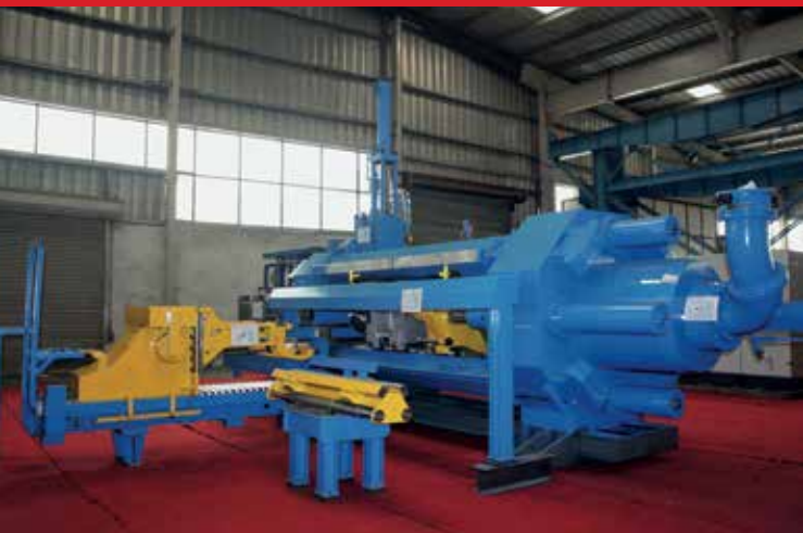
Сделанный в Индии экструзионный пресс с усилием 18 МН готов к отправке заказчику.
