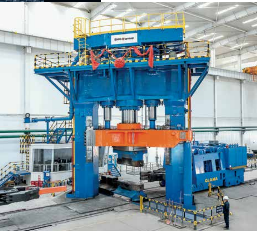
Новый высокоскоростной ковочный пресс с усилием 63/80 МН в действии на предприятии WST.
