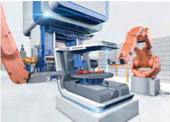
Markierstation: Mittels Nadelprägen wird auf jedes Schmiedeteil ein robuster Data-Matrix-Code aufgebracht.
