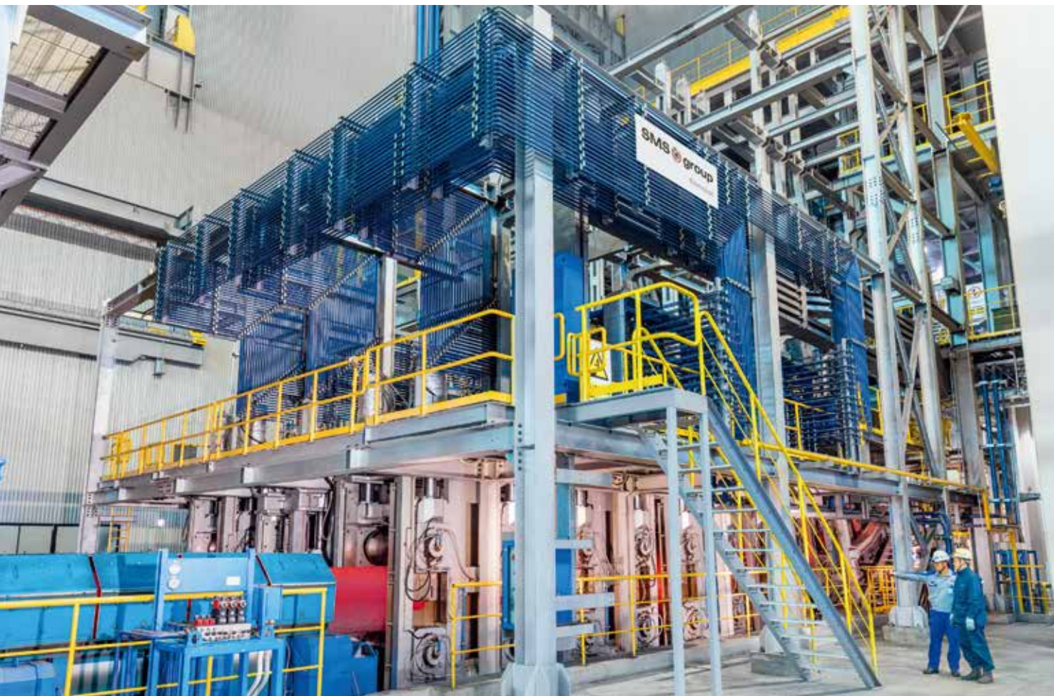
韩国 TAEWOONG 公司成功地在西马克康卡司特连铸机上浇铸出直径为 1000 毫米的大圆坯
