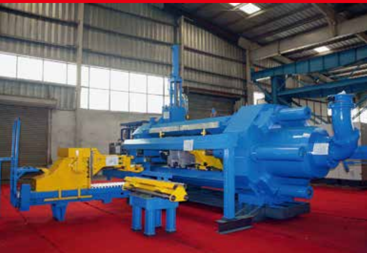
一台组装完毕的 18MN 挤压机，“印度制造”
