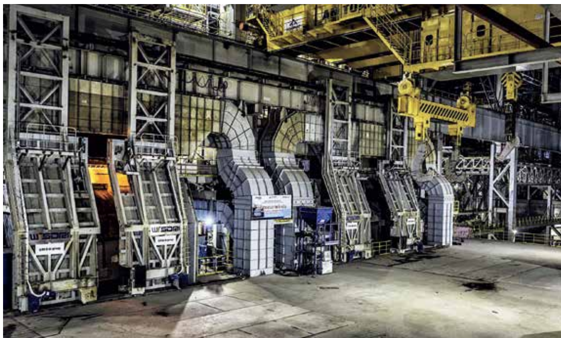
这 4 个 120 吨的转炉将全部配备西马克集团开发的免维护的弹簧板悬挂系统
