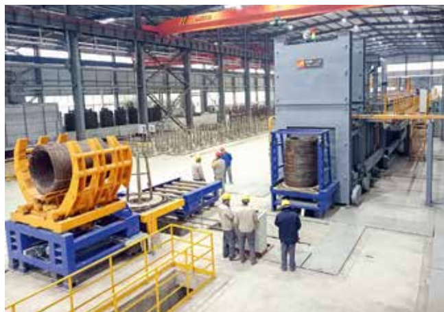
位于入炉侧的线材盘卷连续装料机构
