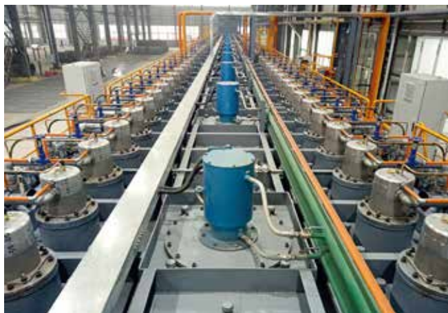
最高炉温 850°C的辐射管连续热处理炉
