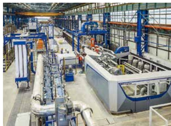
由 HybrEx® 25 混动挤压机组成的新挤压生产线
