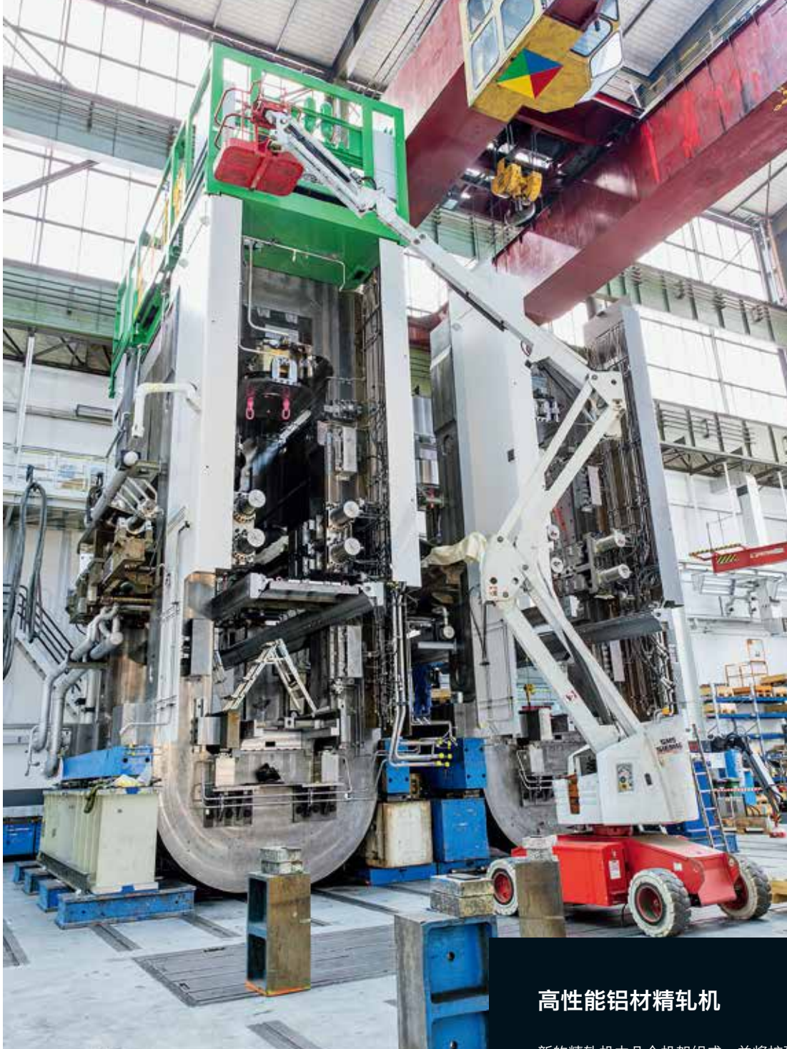
铝材热轧机预装。 在希尔辛巴赫工厂 可以实现总重几百 吨设备的预装
