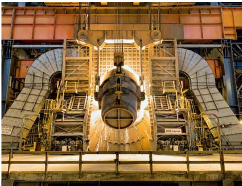
西马克集团BOF 转炉，配有免维护 弹簧板转炉悬挂系统
