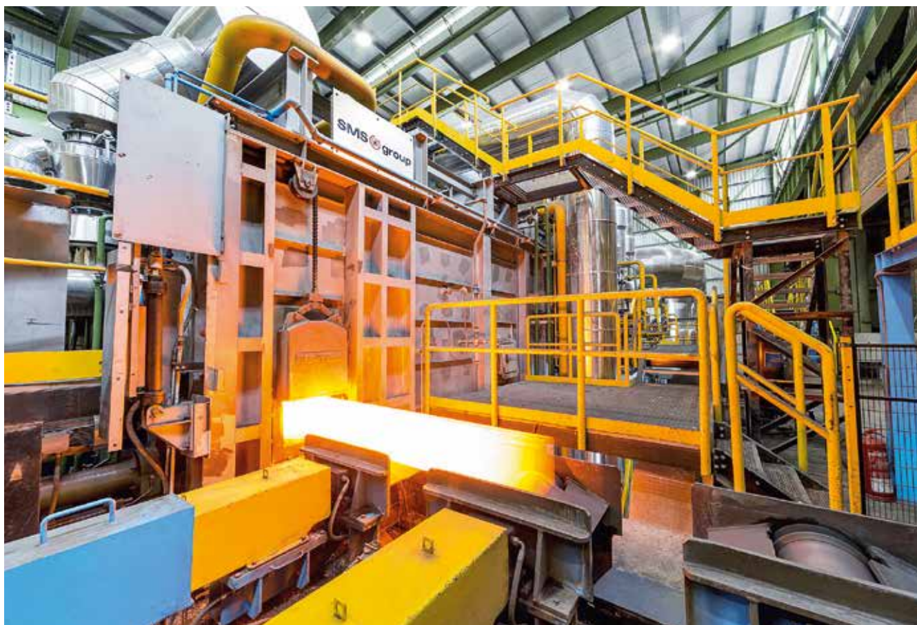
SMS group установила новую печь с шагающими балками и соответствующим оборудованием на входе и выходе.
