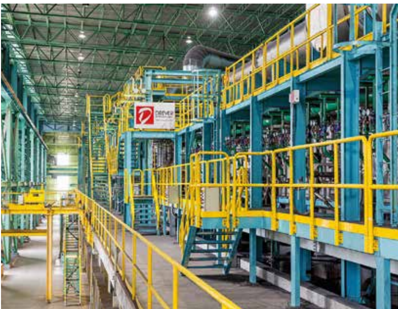
Высокопроизводительная печь Drever International предназначена для ресурсосберегающей и эффективной обработки холодного полосового проката.
