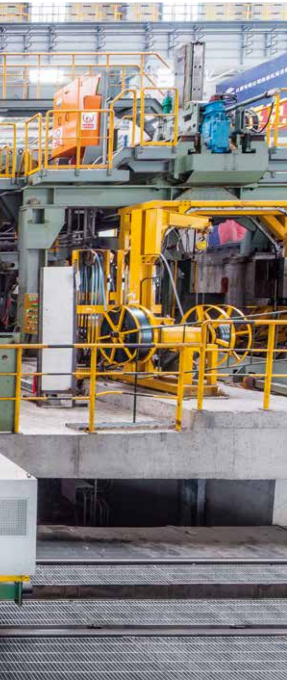
Высокоэффективный стан горячей прокатки оснащен тремя подпольными моталками.
