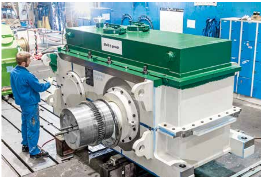
Последний этап изготовления: окраска нового редуктора для предприятия Novelis из Нахтерштедта.
