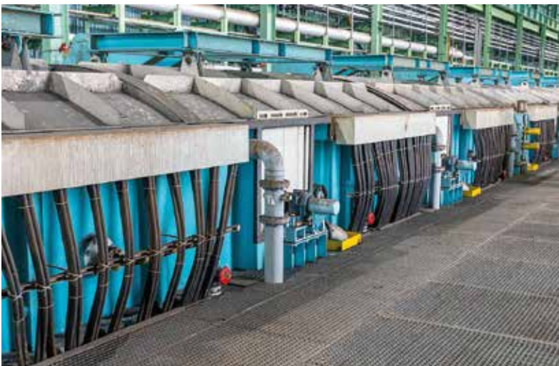
Участок травления обеспечивает хороший результат травления при низких показателях расхода и высокой скорости, она состоит из электролитических секций, секции турбулентного травления и участка промывки с осциллирующими щетками.
