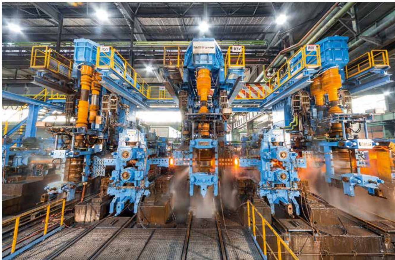
Действующая черновая клеть «трио» была заменена 6-клетевым прокатным станом непрерывного действия с компактными клетями.
