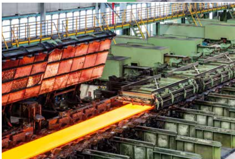
Теплоизоляционные колпаки уменьшают потери тепла в полосе-полуфабрикате.
