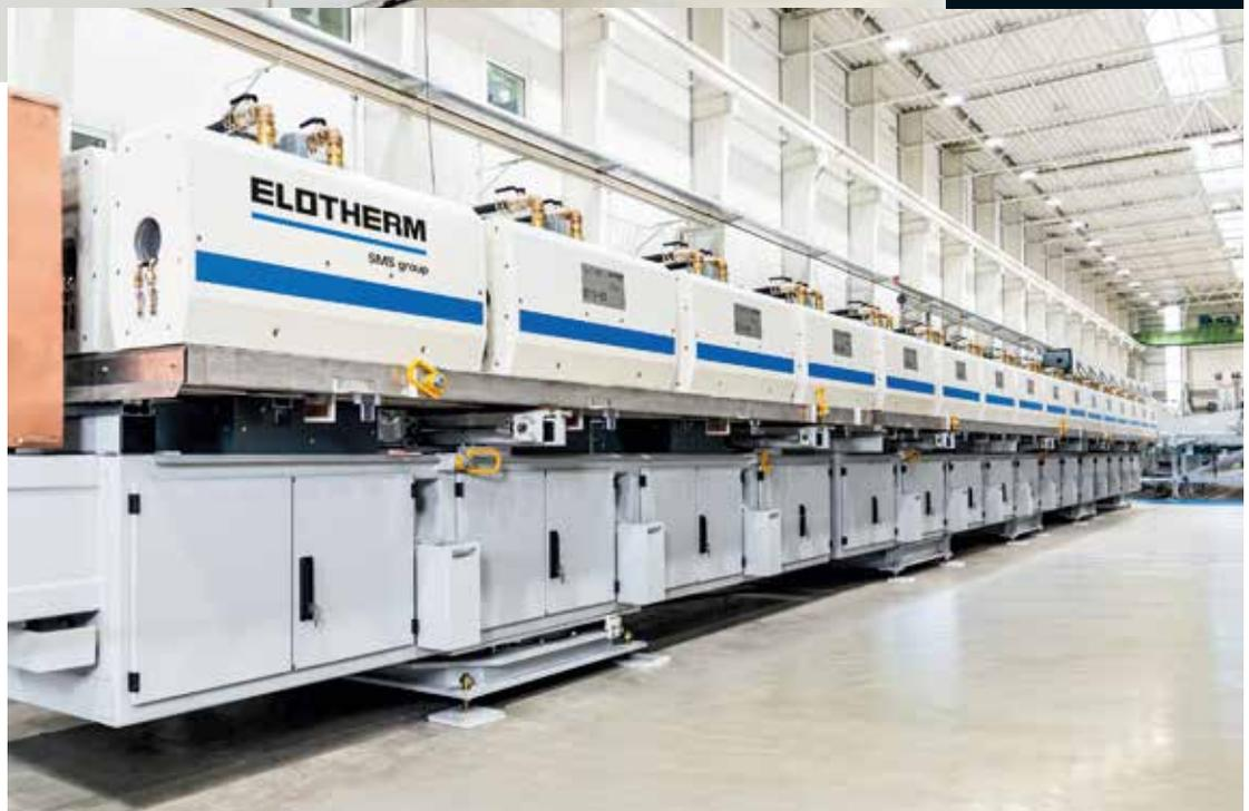
由于铝的热物理特性和锻造温度较低，两个感应器组可以相同的最大产量运行。这意味着安装的逆变器容量可以最佳地用于两种产品。
