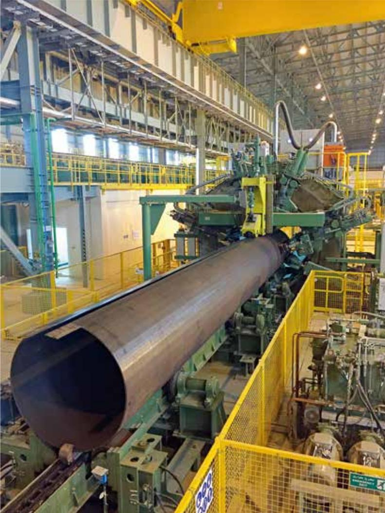
同样是西马克供应范围的一部分：定位焊最先进的大直径管磨机
