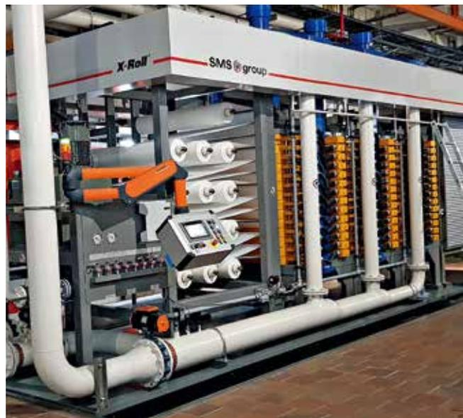
Multi-Plate® 过滤器在Hydro工厂进行最后装配
