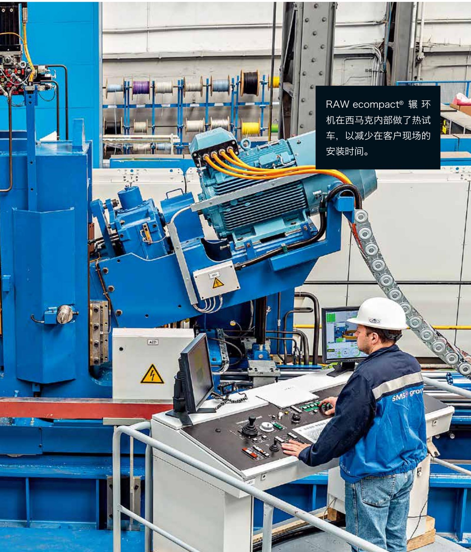
RAW ecompact® 辗环机在西马克内部做了热试车，以减少在客户现场的安装时间。
