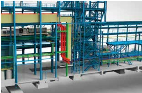
干涉管控 — 虚拟技术可以真实显示钢结构支撑、工艺管路、电缆路径和计划的通道等位置
