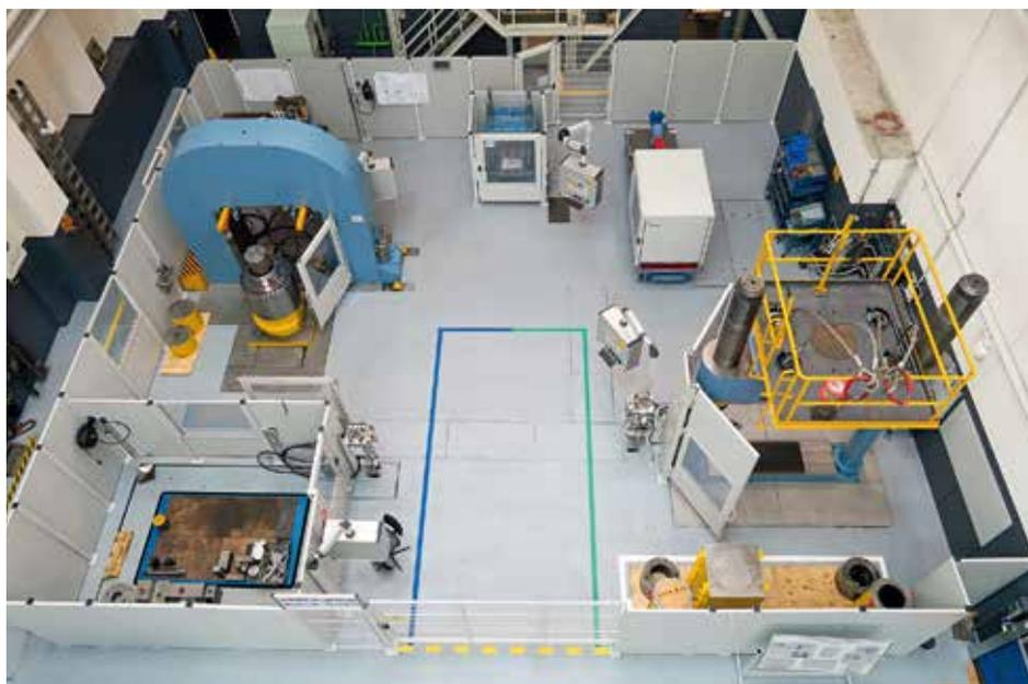
每一个液压辊缝调节油缸在发货前都会在西马克的测试机架上进行测试
