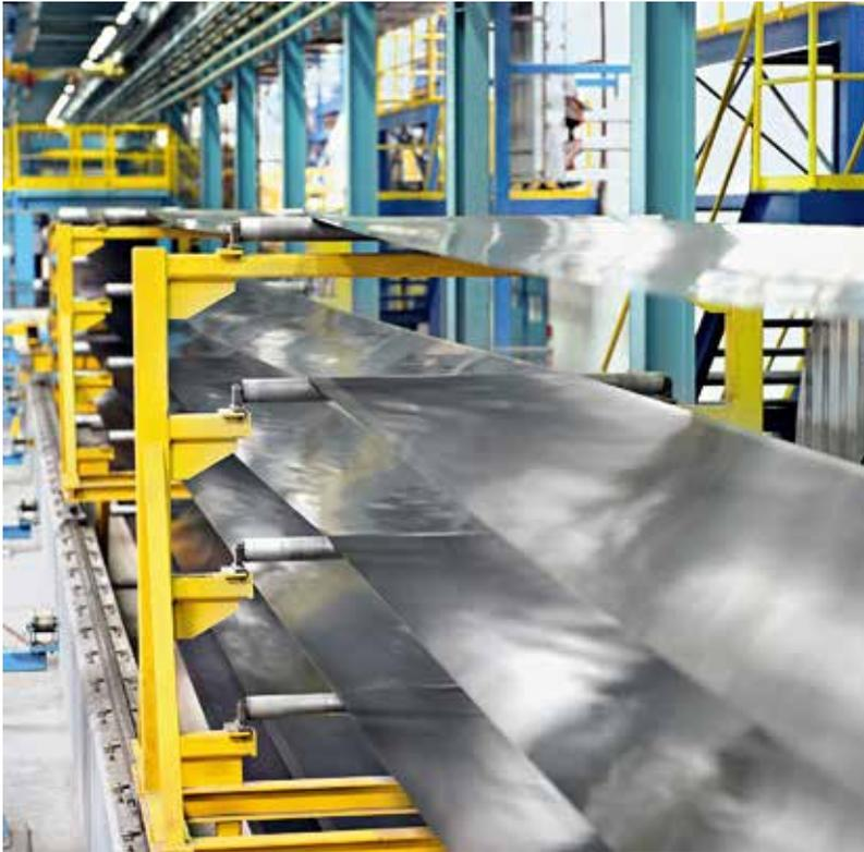
无取向电工钢退火涂层机组
