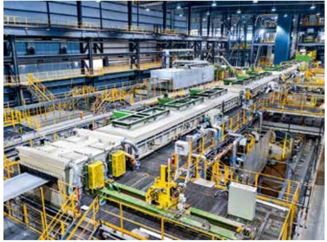
浅槽紊流酸洗以最小的酸液和能源消耗达到最好的酸洗效果
