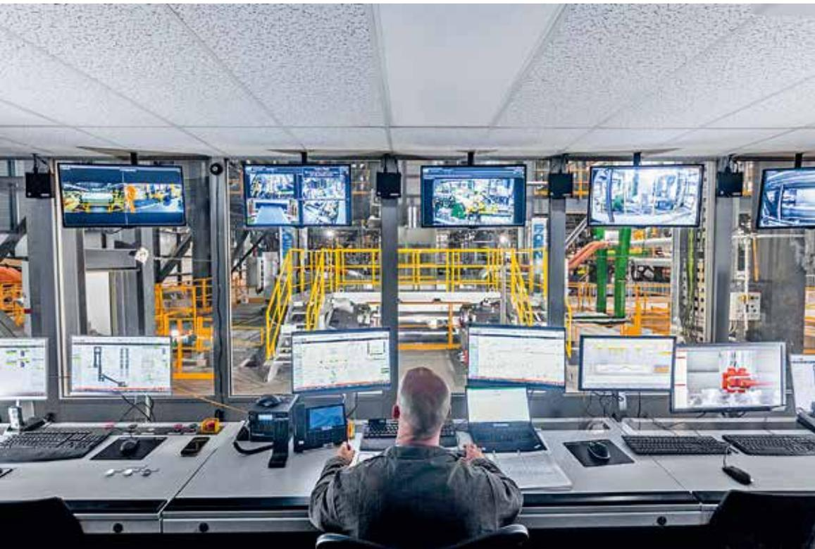
控制室一目了然地显示所有工艺处理的过程和结果，并持续记录产品质量信息。该生产线配备了高水平的数字化和自动化系统。所有的电气和自动化系统、全厂的数字化技术都是由西马克提供，包括X-Pact® 自动化系统和相关的工艺模型、带有质量信息的物料跟踪系统、先进的X-Pact® MES 4.0（生产管理系统）和全厂的数字化传感器系统。
