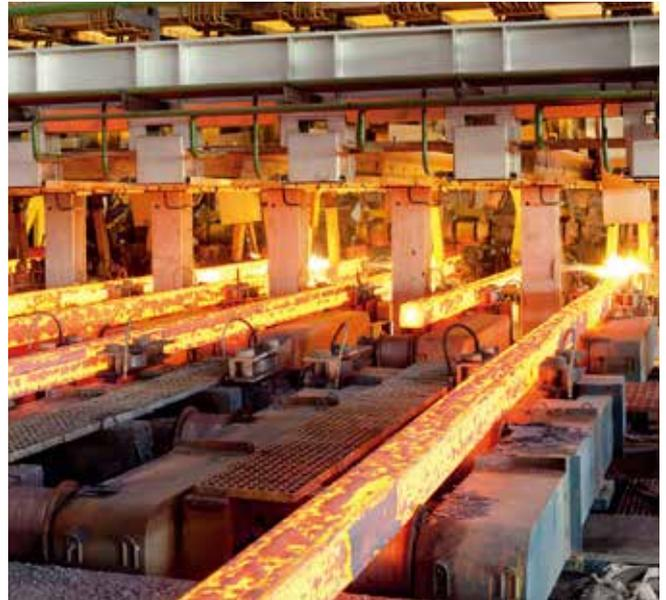
西马克康卡司特连铸机实现八流高拉速浇注
