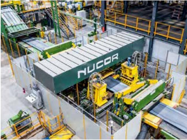
采用高效固态激光源的新一代的X-Pro®激光焊机安全快速地将带钢头尾焊接在一起
