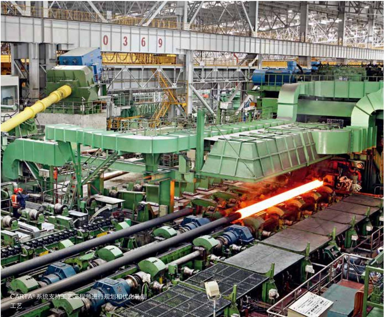
在无缝钢管生产中最后一个工艺段是张力减径。在此荒管的外径在单个机架中减小——总共可达30%——在张力减径机（SRM）中。通过选择性调整轧辊转速，可以建立纵向张力，可用于管材张力延伸以获得精确的壁厚尺寸。作为该过程的一部分，可能会导致来料荒管的几何形状发生变化。此外，在SRM中建立的张力会导致管端增厚，这会降低轧机成材率。使用CARTA®neo，这些异常可以修正过来，减小切头损失和提高SRM生产率。
