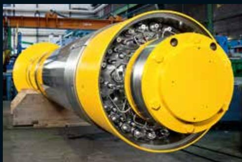
优化过的没有安装防护罩的干油润滑系统
