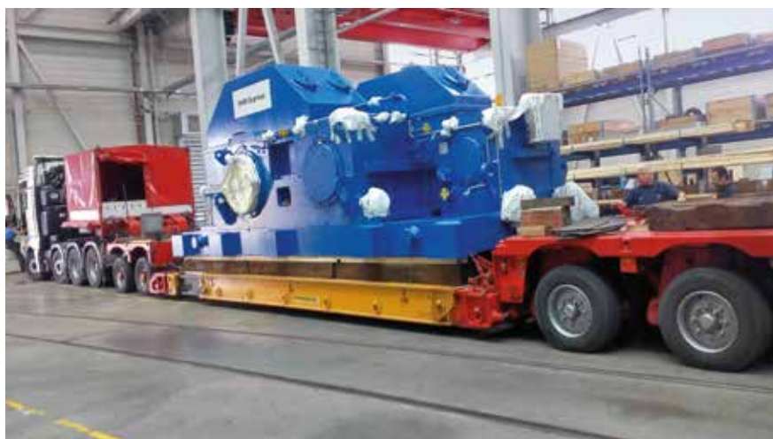
Abtransport des komplett vormontierten Getriebes aus der Werkstatt der SMS group in Hilchenbach.
