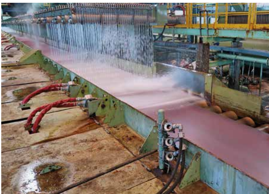
Kühlstrecke im Auslauf der von SMS group modernisierten Warmbandstraße von Ningbo Iron & Steel. Neben der Laminarkühlung wurde auch die Querabspritzung verstärkt.
