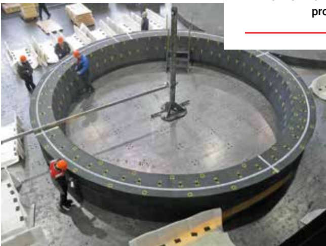
Werkstatt-Kontrollmontage von Gestellringlagen aus Kohlenstoffblöcken.
