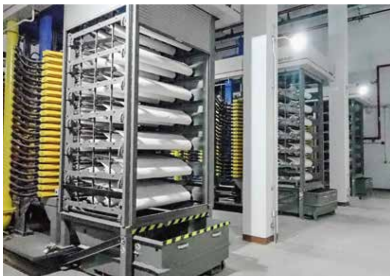
Drei Multi-Plate®-Filter von SMS group reinigen das Walzöl effizient und umweltverträglich.
