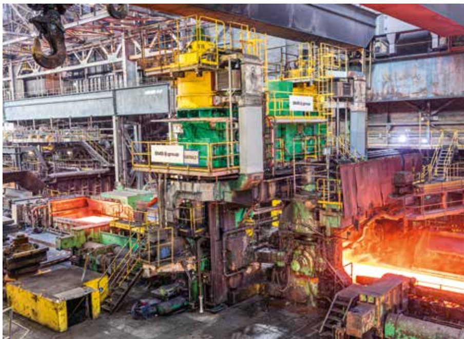
Nachher: Vorgerüst mit Staucher nach dem Umbau. Blick von der Auslaufseite.
