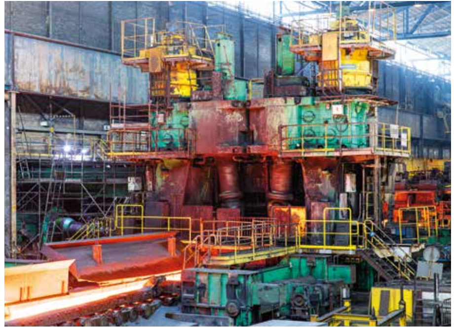
Vorher: Stauchgerüst vor dem Umbaustillstand.
