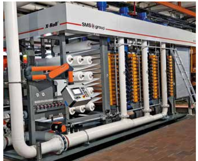
Завершающий монтаж фильтров Multi-Plate® на заводе компании Hydro.
