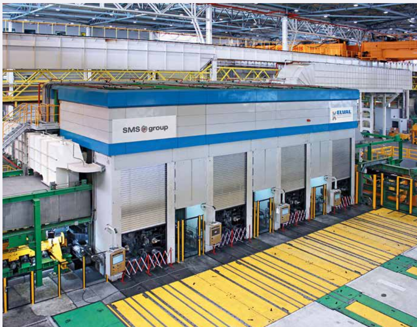
Введенный в эксплуатацию четырехклетевой чистовой прокатный стан на предприятии ElvalHalcor S.A.
