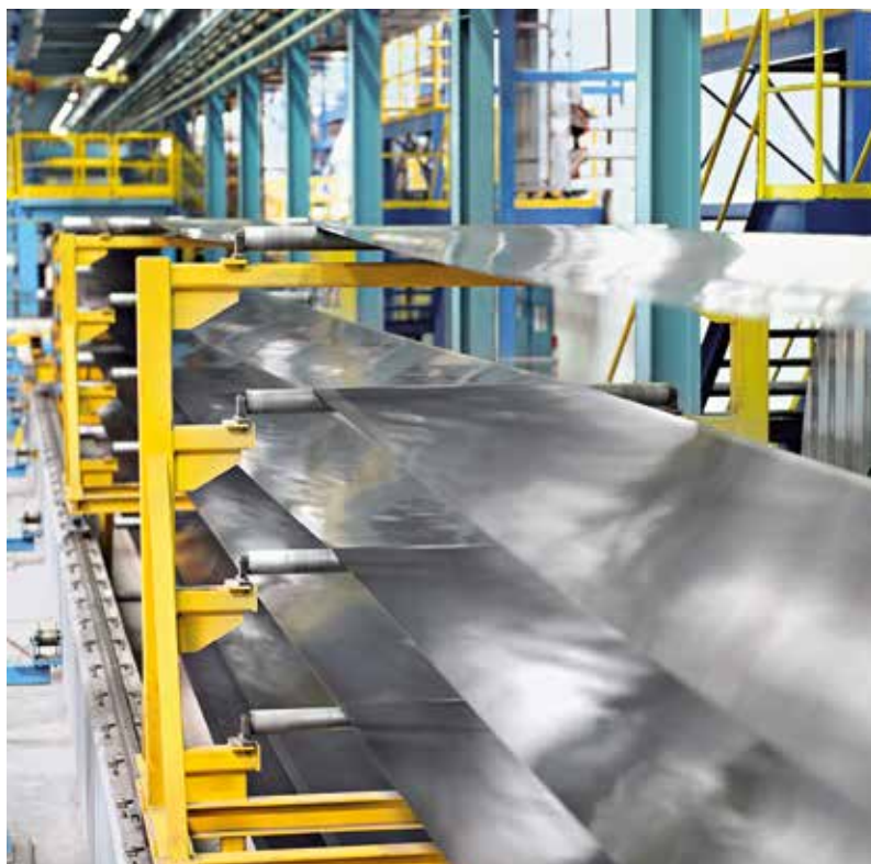
Горизонтальный накопитель полосы на линии отжига и нанесения покрытия для электротехнической стали с неориентированным зерном
