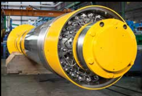
Оптимизированная система консистентной смазки без установленной защитной крышки.
