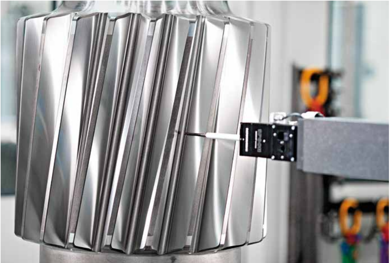
Машина для измерения зубчатых зацеплений в действии.
