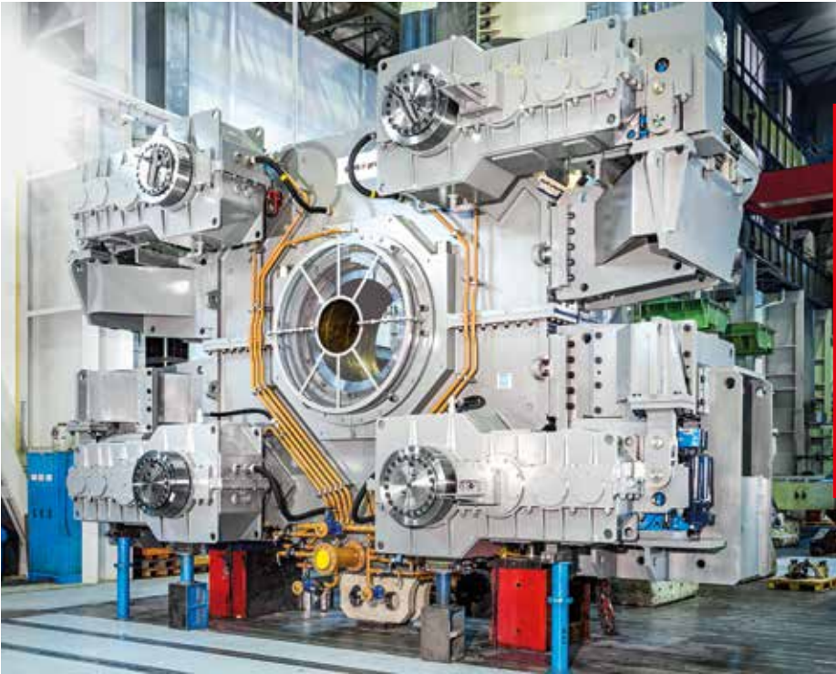
На предприятии Třinecké Železárny были заменены два механизма опрокидывания.
