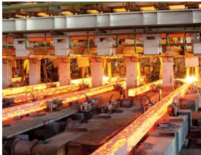
Непрерывное литье на восьми ручьях с использованием высокоскоростной технологии от SMS Concast.
