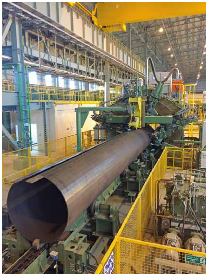
В объем поставки SMS также входит сварочно-сборочный стан для ультрасовременного завода по производству труб большого диаметра.
