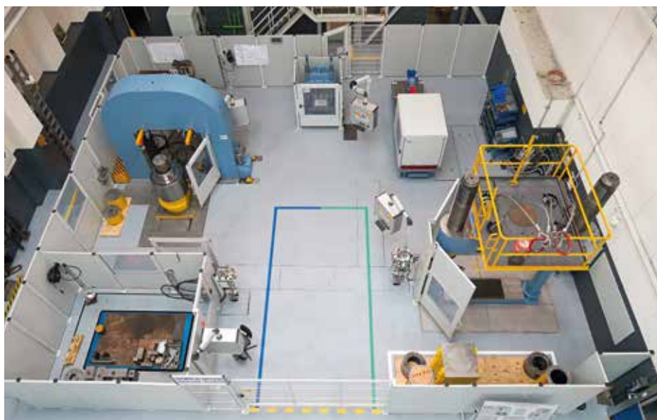
Каждый нажимной цилиндр перед поставкой проходит тестирование на испытательном стенде.
