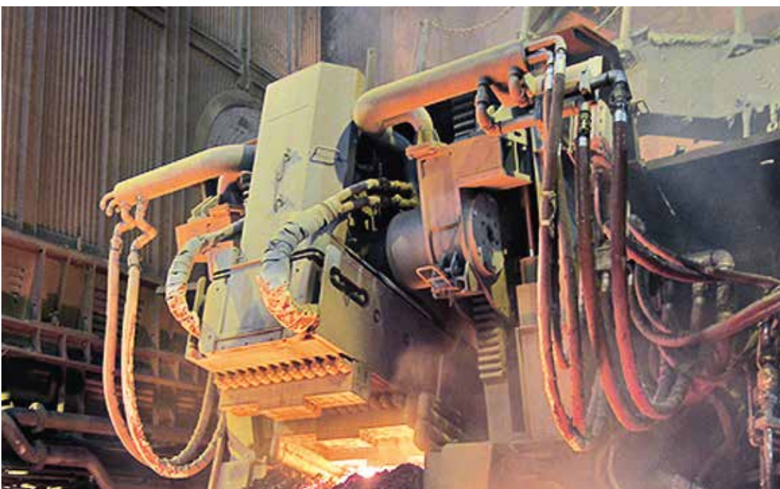
CONDOOR®-Schlackentür mit automatischer Reinigung.
