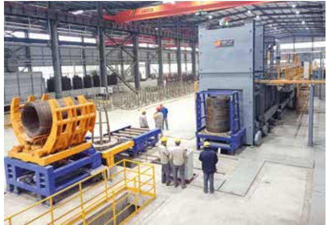
Im Einlauf werden die Bundstapel kontinuierlich dem Ofen zugeführt.
