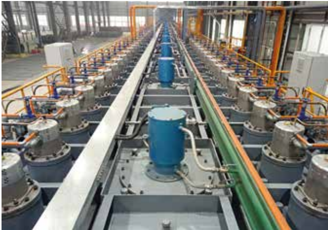
Strahlrohre erhitzen den Ofen auf bis zu 850 Grad Celsius.
