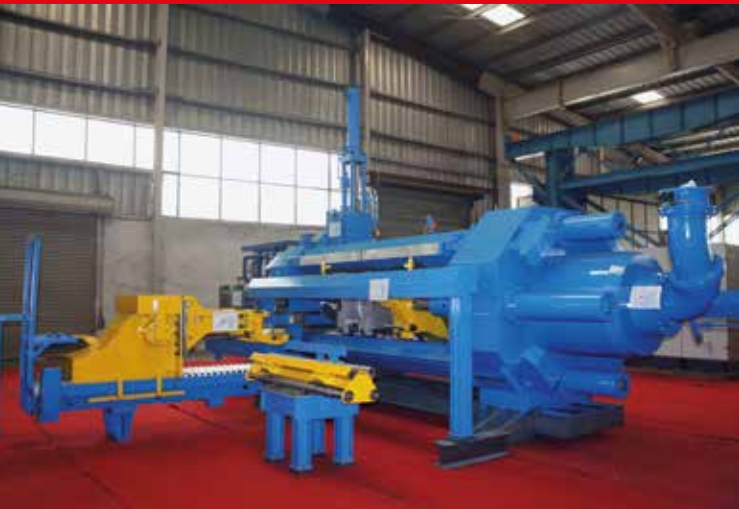
Eine 18-MN-Strangpresse „Made in India“, bereit zur Lieferung an den Kunden.
