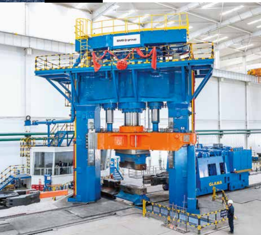
Die neue 63/80-MN-Hochgeschwindigkeits-Freiformschmiedepresse im Betrieb bei WST.
