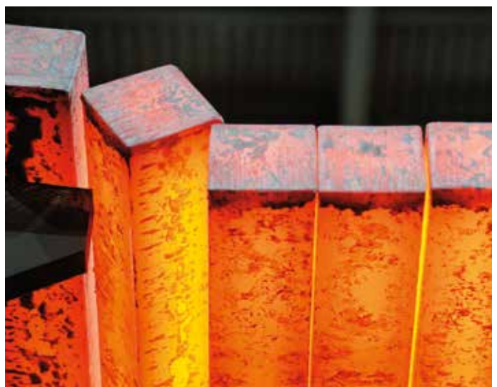
Rechteckige Vorblöcke auf einer Stranggießanlage von SMS Concast vergossen.
