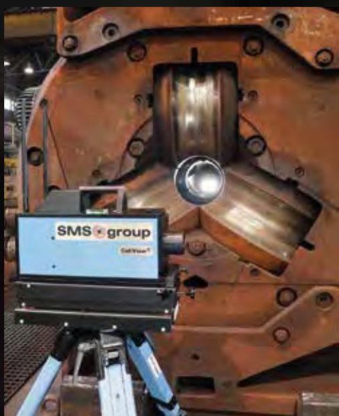
CaliView ® -Messsystem für die Inline-Kalibrierung von Walzwerk und Kalibern.
