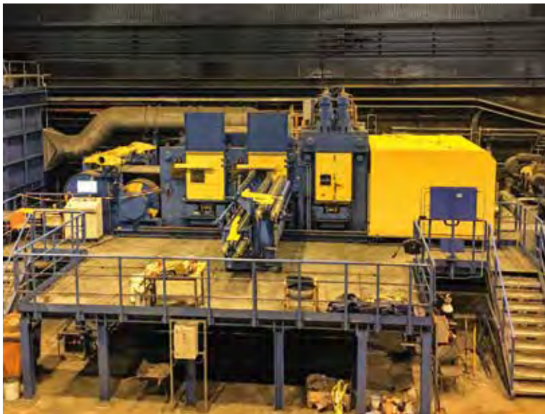
Der Zunderbrecher ist für die Verarbeitung von hochfesten Bändern ausgelegt.
