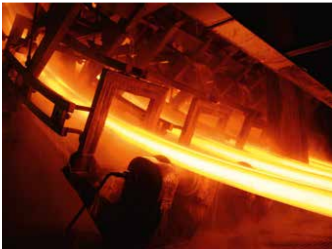
Blick in die Kühlkammer einer Knüppelstranggießanlage.
