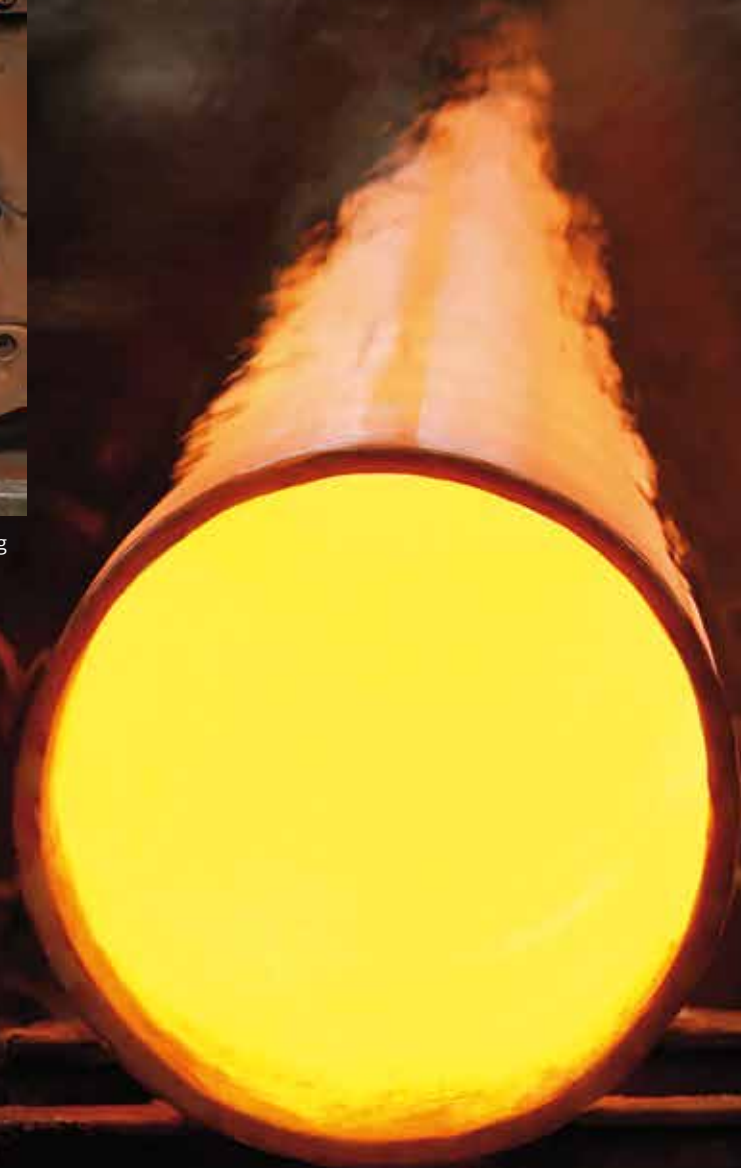
CaliView ® -Messsystem für die Inline-Kalibrierung von Walzwerk und Kalibern.
