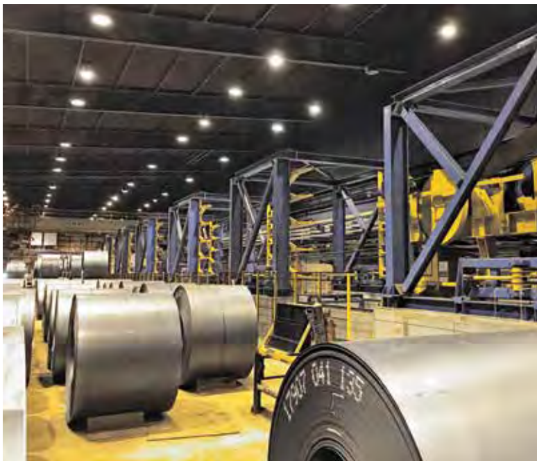
Im horizontalen Sechsfach-Schlingenspeicher können 410 Meter Band gespeichert werden, so dass die Prozessgeschwindigkeit von 180 Metern pro Minute kontinuierlich aufrechterhalten werden kann, während im Einlauf die Coils verschweißt werden.
