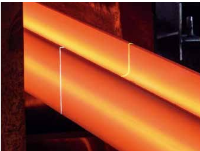
热轧后型钢的激光轮廓测量与缺陷检测
