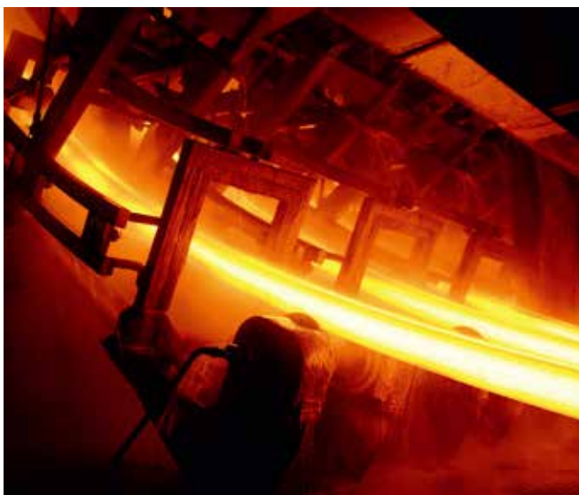
方坯连铸机的二冷室
