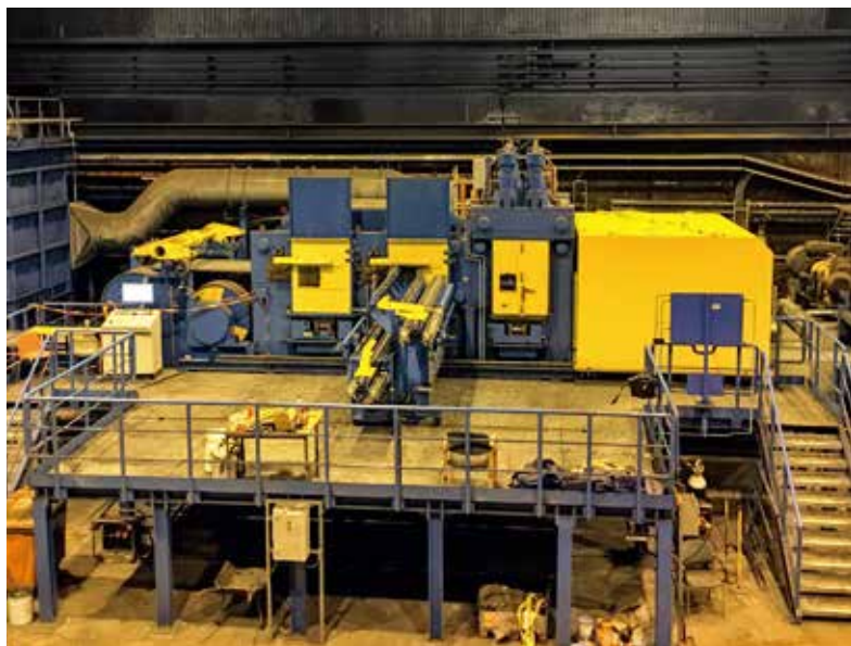
除磷机设计用于加工高强度钢带
