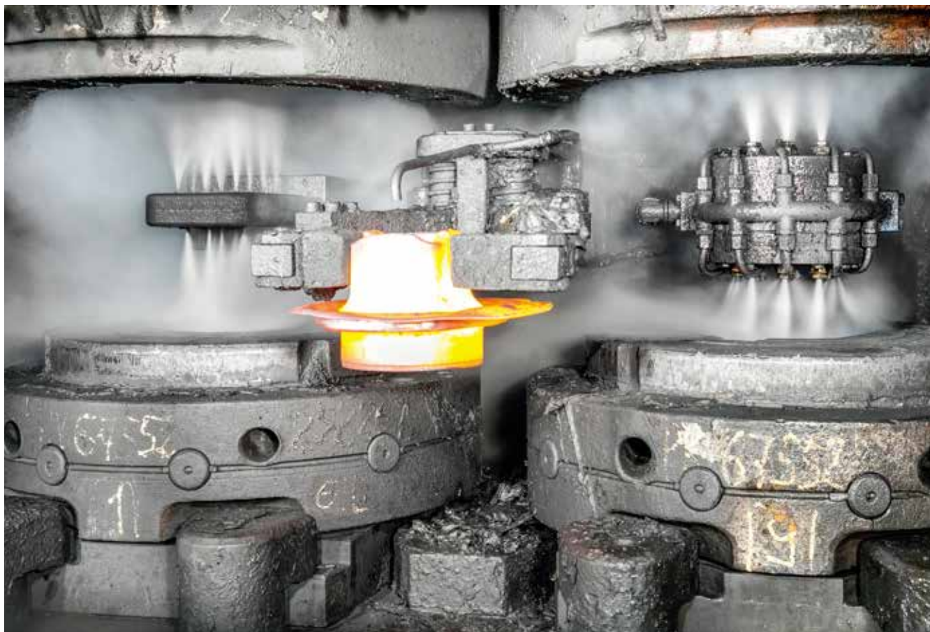
模锻压机内部区域的视图，增材制造的喷淋头（左）和传统工艺的喷淋头（右）
