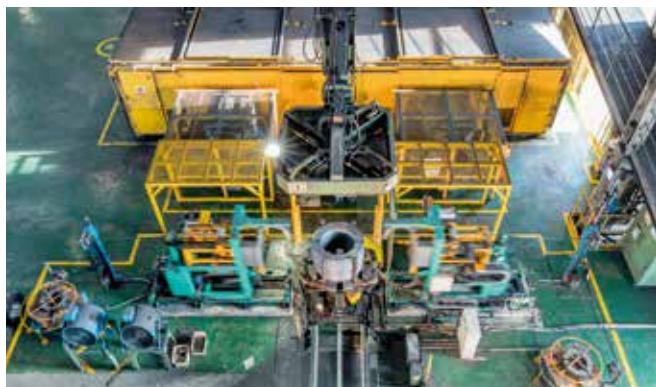
在立式状态下进行直接卷取
