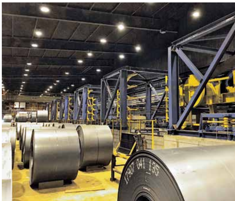
卧式六维活套能够折弯 410 米的带钢，并且把带材在入口段焊接在一起，可保持每分钟 180 米的恒定加工速度
