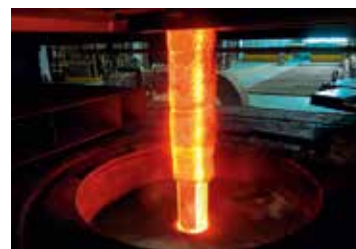
图2: Congauge LB 6755 多晶体传感器提供的增 强辐射测量
