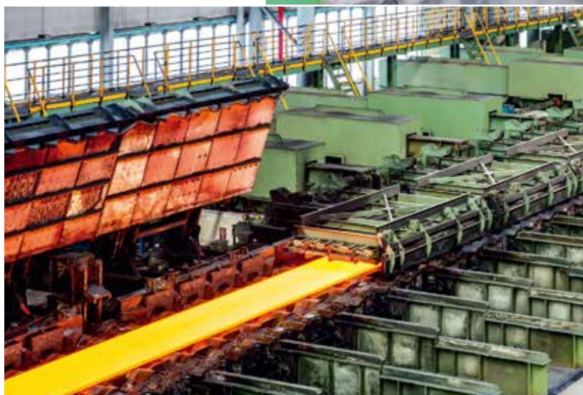
保温罩减少中间坯的热损
