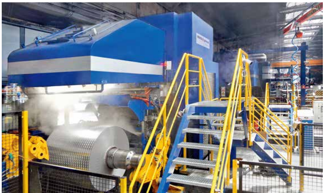
由西马克集团改造 的铝冷轧机正在生 产花纹铝带
