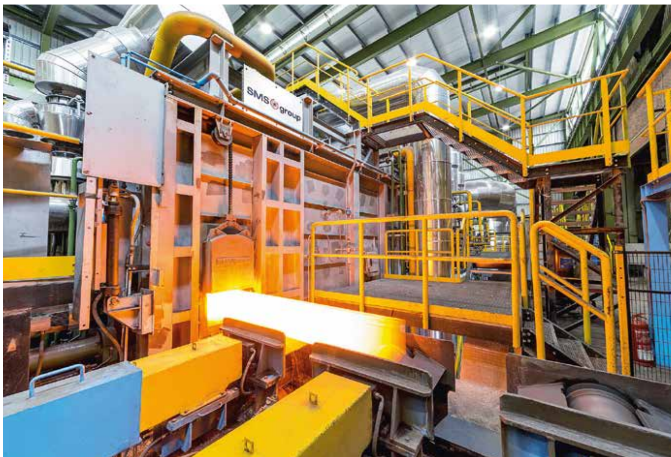
西马克集团供货的全新步进式加热炉以及炉前和炉后设备
