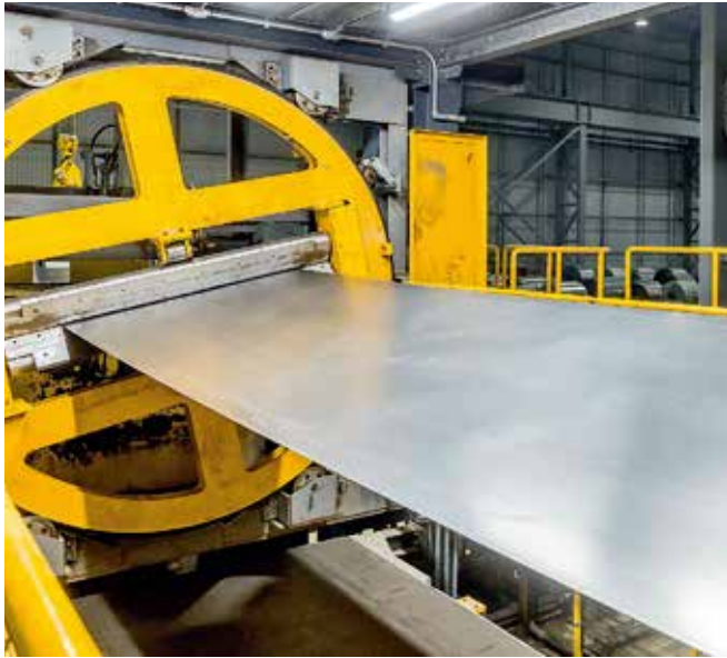
全新的出口侧区域包括最新的离线旋转检测台，对带材上下面进行符合人体工学的快速检验
