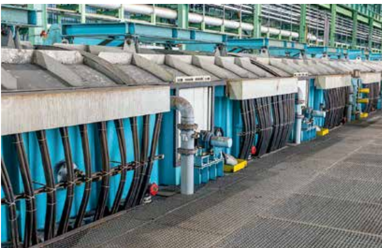
由电解酸洗、紊流酸洗、窜动式刷辊以及后续漂洗组成的酸洗段消耗低、速度快、产品质量高
