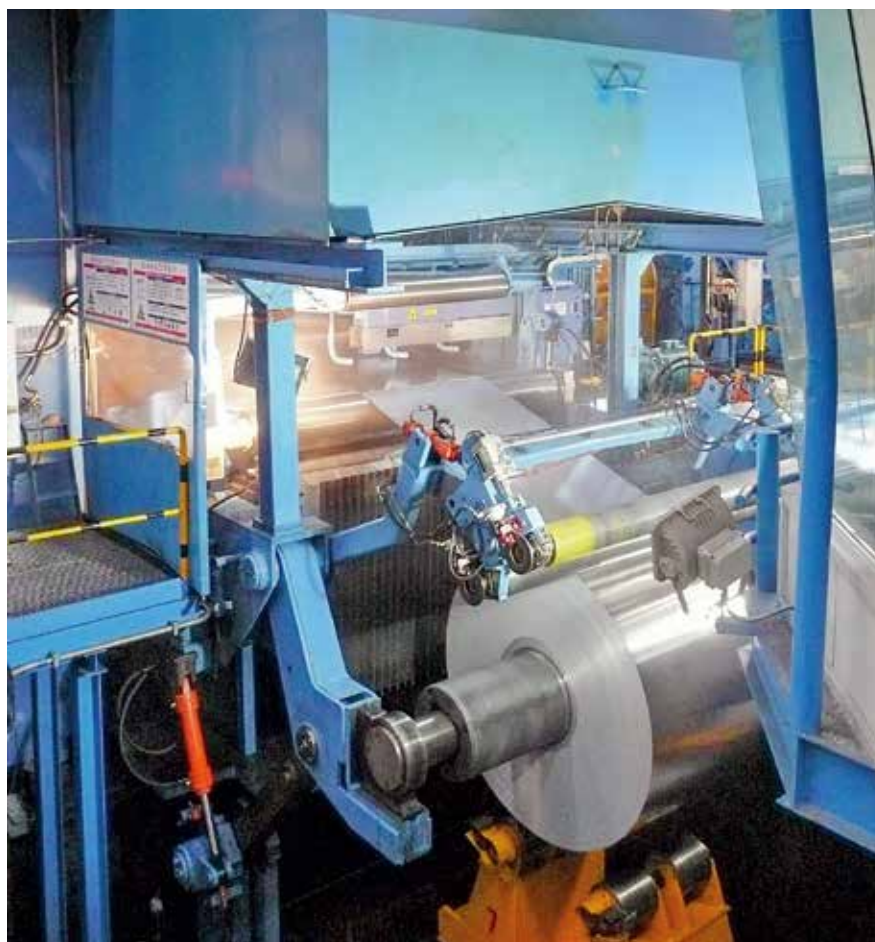
双重拉深辊协助铝带 精确卷取
