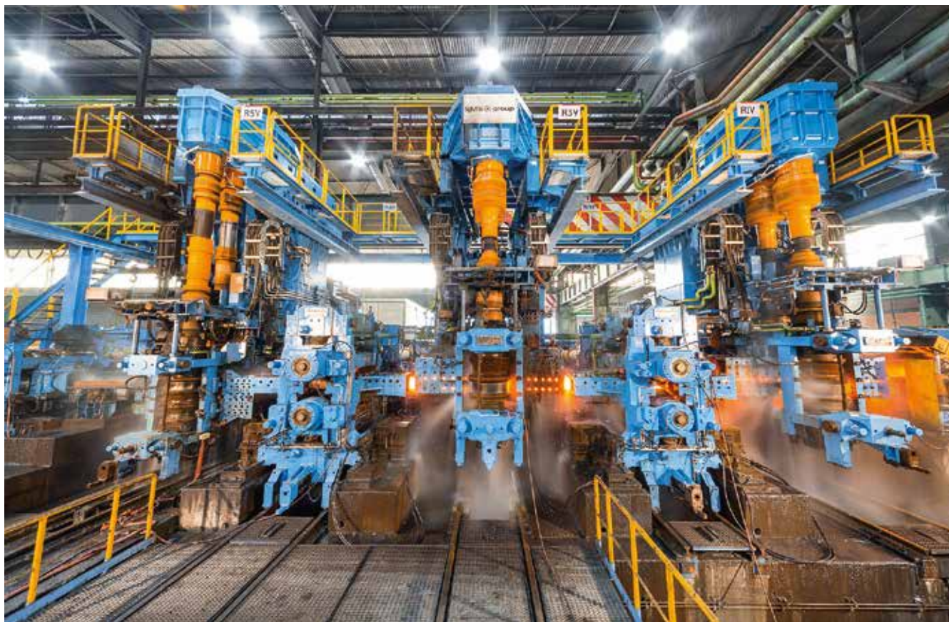
改造之前的三辊粗轧机，已被替换为一组6机架紧凑型连轧粗轧机
