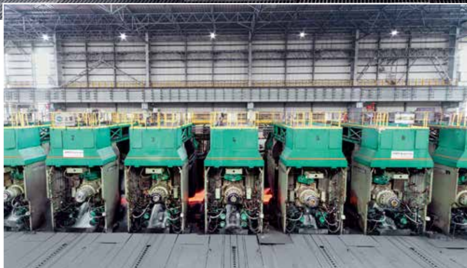
7机架精轧机将中间坯轧成最终厚度。 所有机架均装有CVC®plus技术
