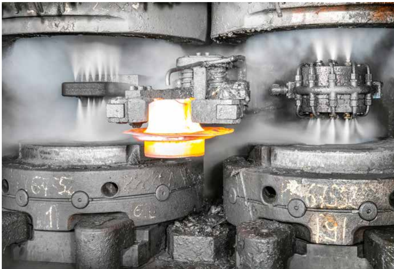
Пресс кузнечно-штамповочного цеха. Распыляющие головки, изготовленные с помощью аддитивной технологии (слева) и традиционным способом (справа), в действии.
