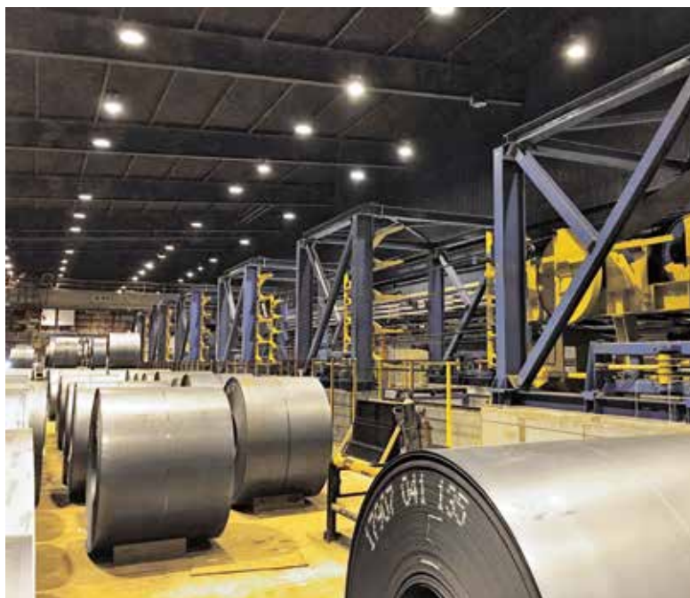
В горизонтальном шестисекционном петлевом накопителе можно хранить 410 м полосовой стали, что позволяет поддерживать постоянную скорость процесса 180 м/мин, в то время как на входе выполняется сварка рулонов.
