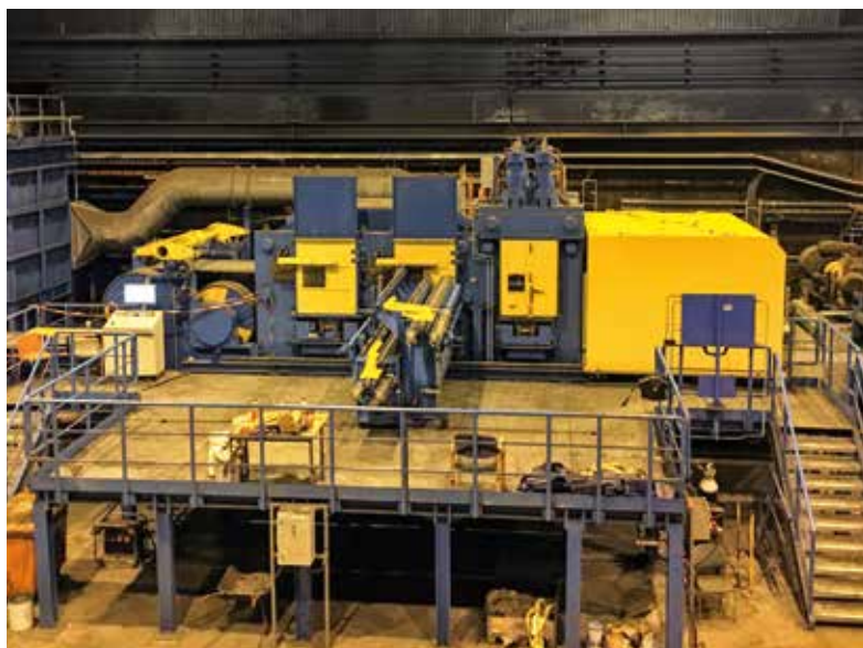
Окалиноломатель сконструирован специально для обработки высокопрочной полосовой стали.
