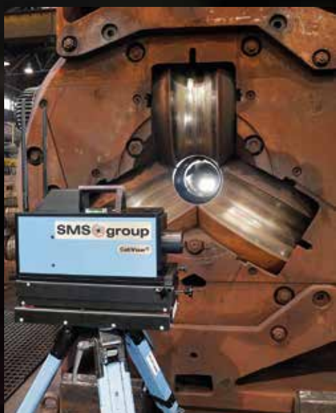
Измерительная система CalView® для встроенной калибровки прокатного стана и калибров.
