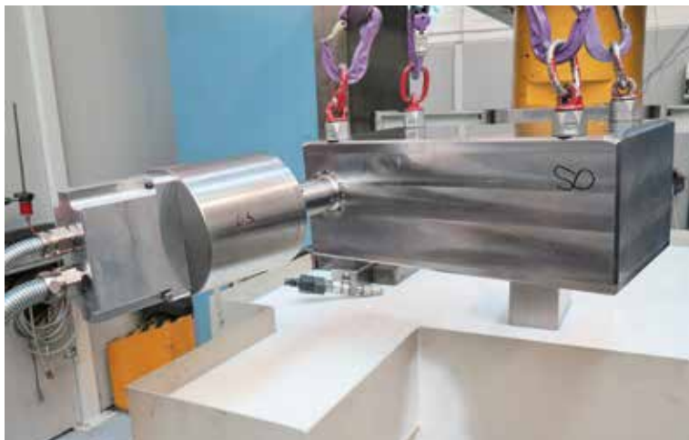
Коробка исполнительного механизма во время испытаний на заводе SMS group в Хильхенбахе.
