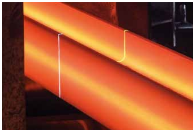
Лазерная система угловых и линейных измерений и контроля поверхности на горячей двутавровой балке.
