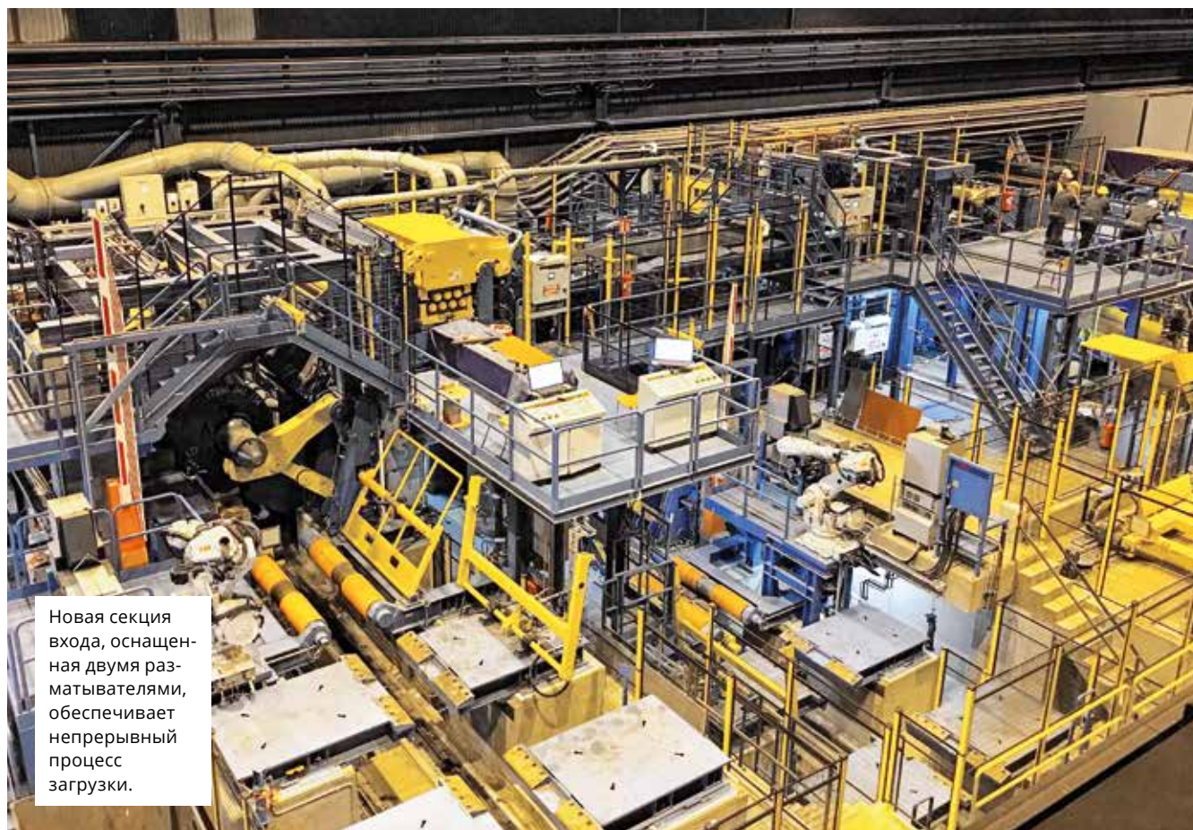
На входе линии травления на заводе SSAB лазерная сварочная машина X-Pro с помощью волоконного лазера быстро и полностью автоматически соединяет даже трудносвариваемые полосы в бесконечное полотно.
